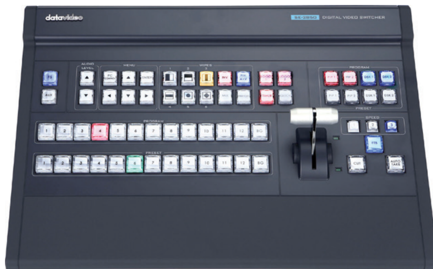
Les commandes sur les pupitres des mélangeurs vidéo sont toujours organisées de la même manière, avec les barres de présélection des sources et la T-Bar pour commander l'avancement de l'effet vidéo, sélectionné avec les boutons en partie supérieure. Photo du clavier du mélangeur Datavideo SE-2850. © Datavideo
