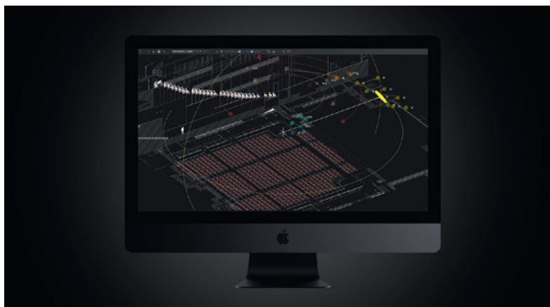
Avec l'application de gestion de l'Amadeus Holophonix, les différentes enceintes et objets se placent dans un plan en 3D pouvant être manipulé dans tous les sens.
