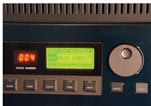
Le processeur Yamaha utilise des preset pour effectuer des rappels de configuration pour l'Atmos ou les filtres ASX. © O. Verrecchia
