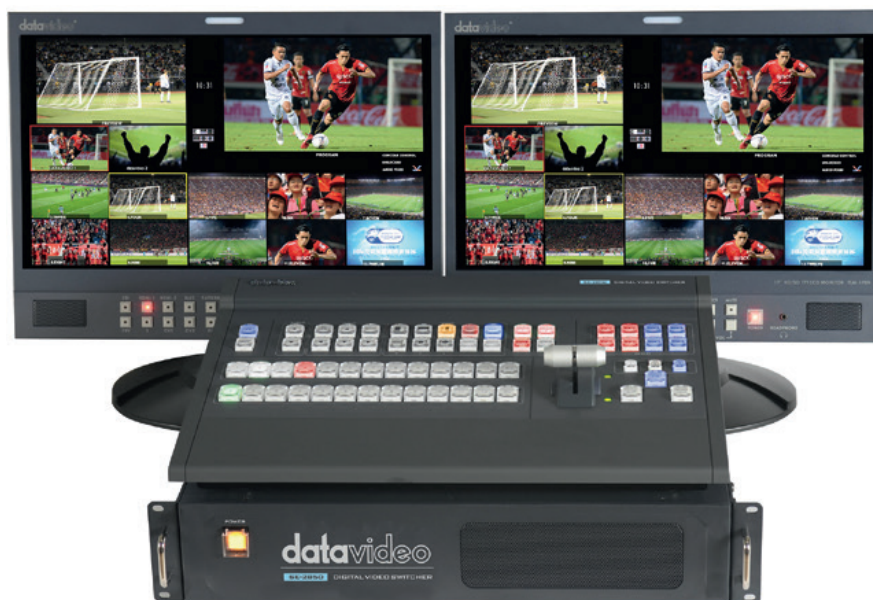
Tous les mélangeurs vidéo, comme ici le Datavideo SE-2850, sont équipés d'une sortie multiviewer affichant sur un ou plusieurs écrans les images de sortie et, en vignettes, les sources, les informations de tally, les niveaux audio et une horloge. © Datavideo
