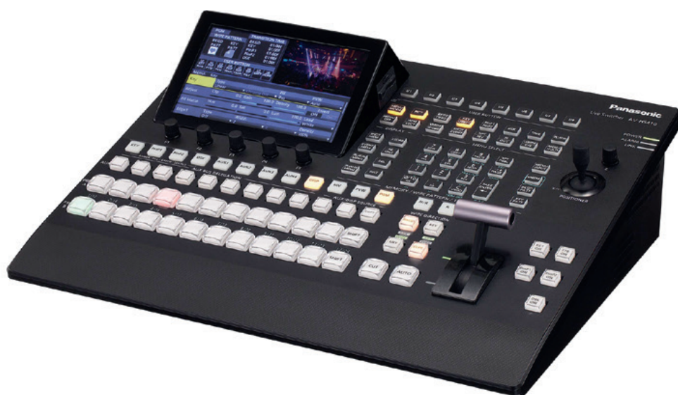
Pour augmenter ses capacités en entrées et en sorties vidéo, le mélangeur Panasonic AV-HS410N reçoit des cartes modulaires en option. © Panasonic
