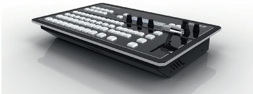
Le mélangeur vidéo Carbonite Solo de Ross Video est un modèle monobloc regroupant le pupitre de commande, l'électronique et le panneau de connecteurs sur la face arrière. © Ross Video
