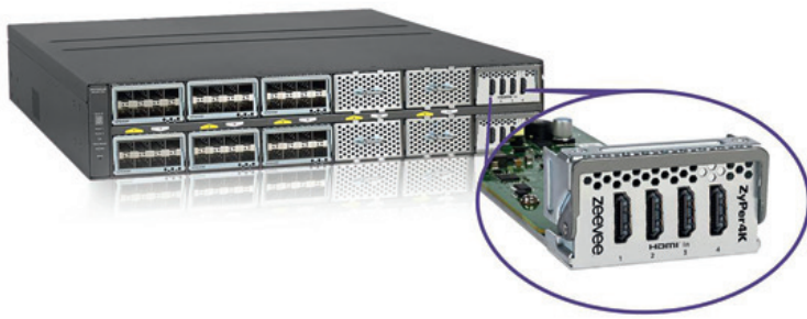
En complément aux modules de connecteurs RJ-45 ou fibres optiques, le switch réseau reçoit un module de conversion HDMI de ZeeVee. © Netgear - ZeeVee
