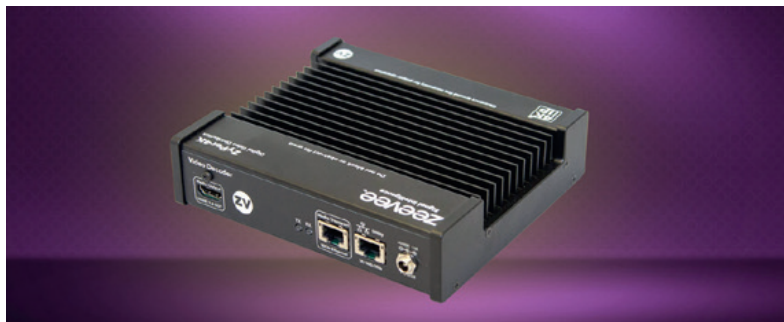
Le décodeur ZeeVee Zyper4K fournit en sortie HDMI des images 4K non compressées. Pour préserver le silence, il fonctionne en mode « fanless ». © ZeeVee
