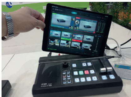
Ce mélangeur vidéo de direct est dédié à la production pour le web ; il utilise un iPad comme écran de visualisation et accepte une entrée HDMI 4K ainsi que deux entrées HDMI en 1 920 x 1 080p ; il comporte aussi un mélangeur audio et un encodeur de streaming. © Antoine Gruber
