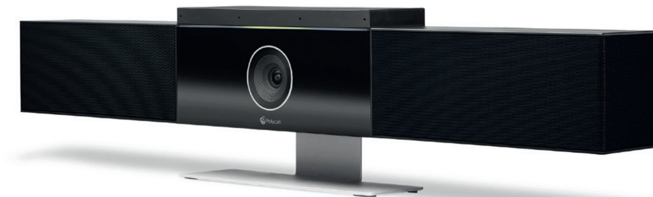
La barre vidéo Studio de Poly regroupe à la fois une caméra vidéo UHD avec fonctions PTZ, un réseau de six capsules micros et un ensemble de haut-parleurs stéréophoniques. © Poly
