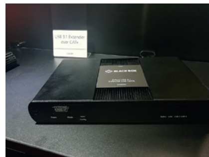
Nouvel extender pour USB-C chez BlackBox, ce modèle comporte quatre ports d'entrée et fonctionne sur câble Cat6. © Antoine Gruber
