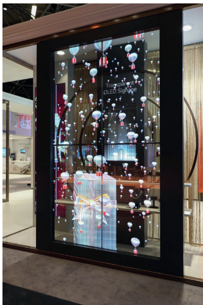
L'affichage LED est possible en transparence chez LG, soit avec des écrans OLED, soit avec des films à coller directement sur des surfaces vitrées, qu'elles soient planes ou courbes.
