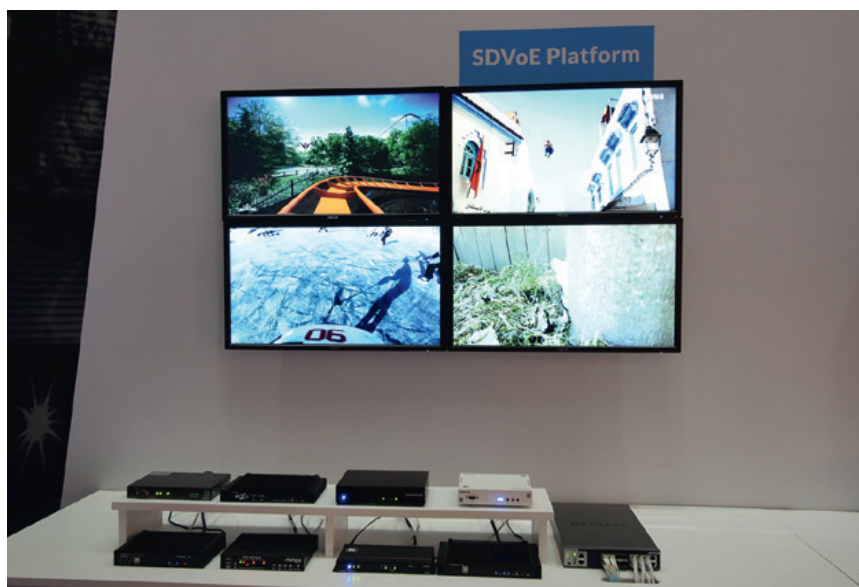
Le protocole SDVoE pour l'AV-sur-IP est universel : un système avec quatre encodeurs et quatre décodeurs, tous de fabricants différents, en faisait la démonstration. © Alban Amoureux
