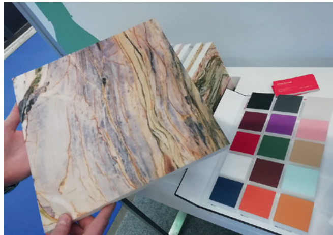
La société Vicoustic, qui fabrique des panneaux de traitement acoustique, a développé un matériau absorbant à base de bouteilles en PET recyclées. Le produit est proposé avec un motif d'impression décoratif sur catalogue ou sur demande. © Antoine Gruber
