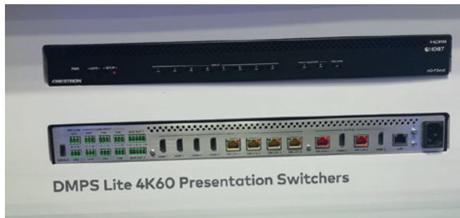
Crestron décline le Digital Media avec une série DM-Lite, ici le processeur routeur DMPS et un récepteur à ce format. Le DM Lite est une version économique du système DM, il permet de transmettre une image HD à 70 mètres et une image 4K60 à 40 mètres. De nombreux modules existent déjà au catalogue pour toutes les situations. © Antoine Gruber
