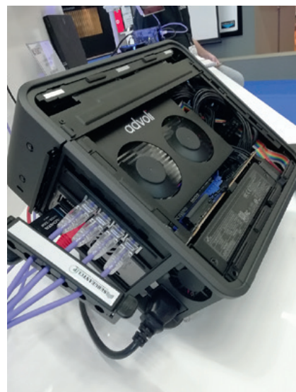
Le nouveau Nuc d'Intel est ici équipé d'une carte Advoli à quatre sorties HDBaseT, pour des applications multi écrans. © Antoine Gruber
