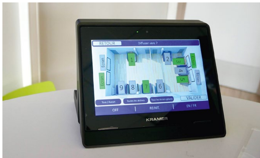
Sur l'écran tactile de contrôle, les sources d'images et les écrans de diffusion sont dessinés selon leur emplacement dans la salle. © PA Taufour
