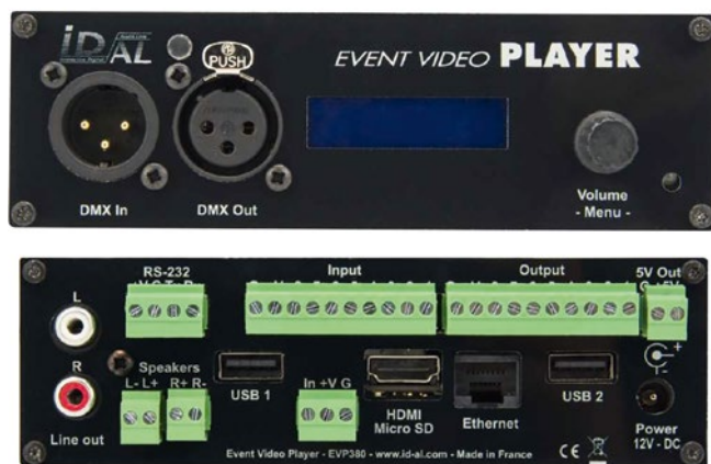
L'EVP380 est le show controller le plus complet proposé par ID-AL. Ses nombreux ports GPIO peuvent recevoir boutons, capteurs, détecteurs. ID-AL documente précisément les multiples possibilités de câblage à ce sujet. © Optoma
