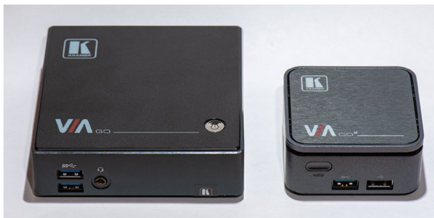
La nouvelle passerelle sans fil Kramer VIA Go2 est beaucoup plus petite que son ancienne version. Sa taille de 7 x 7 cm facilite son montage derrière un écran ou dans un meuble. © Kramer
