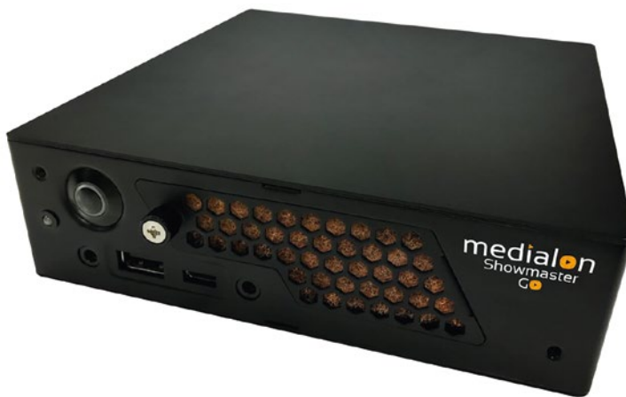
Dans un format ultra compact, le Medialon Showmaster Go renferme quatre sorties DisplayPort, 16 canaux audio Dante et trois ports GPIO pouvant être étendus à travers le réseau. © Medialon
