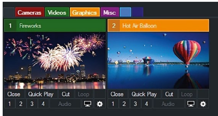
Pour faciliter le repérage des sources d'images, le logiciel vMix offre un outil pour les regrouper par catégorie et leur affecter un code de couleurs. © vMix
