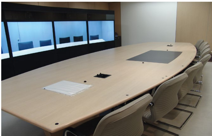
Cette salle de téléprésence Cisco est construite pour donner l'illusion à chacun qu'il est physiquement face à ces interlocuteurs. Pour ce faire les échelles, taille d'image, distance à l'écran, lumières sont parfaitement respectées. © Antoine Gruber
