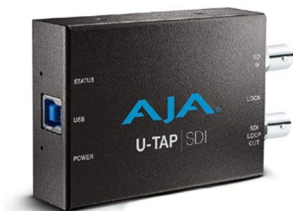
Le boîtier U-TAP d'AJA convertit dans les deux sens des signaux SDI pour les rendre compatibles avec un port USB d'ordinateur. Il est reconnu par une très large gamme de logiciels. © Aja
