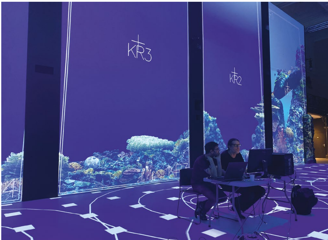
Les projecteurs ne sont pas du tout installés dans l'axe de projection et leurs parallaxes sont corrigées par le logiciel AAASeed. © Philippe Fitte
