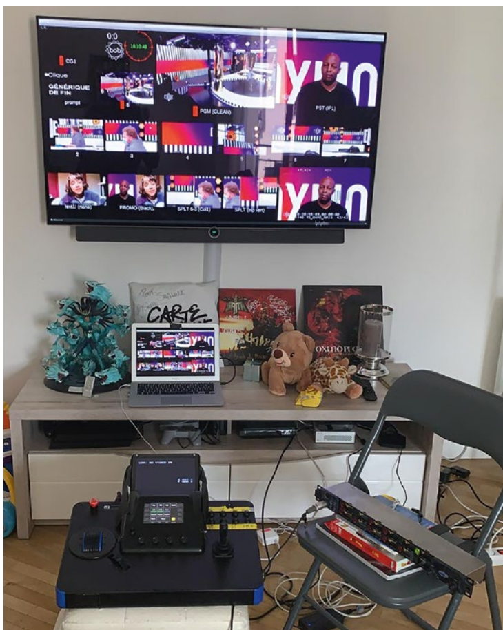
Le poste de travail du cadreur chez lui avec le pupitre de télécommande et son panel d'intercom à droite. L'affichage multiview est renvoyé sur son téléviseur. © BOB
