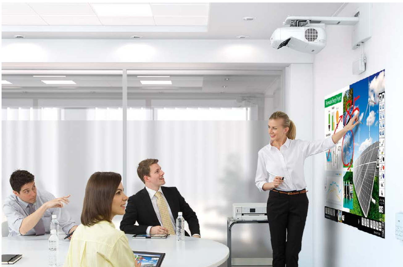
Le vidéoprojecteur à courte focale évite les ombres portées et l'éblouissement de l'orateur. © Epson
