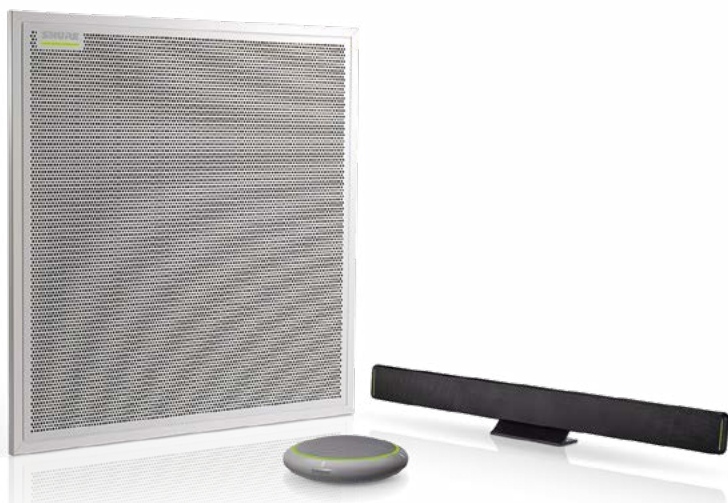
Le MXA 910 de Shure est constitué de cent-vingt capsules pour pouvoir créer jusqu'à huit lobes de directivité, tous montés sur des canaux Dante. Le micro linéaire MXA 710 est lui décliné en deux longueurs : 60 cm ou 1,20 m, pour quatre ou huit lobes, pour être adapté d'une petite huddle room jusqu'à des salles moyennes.
