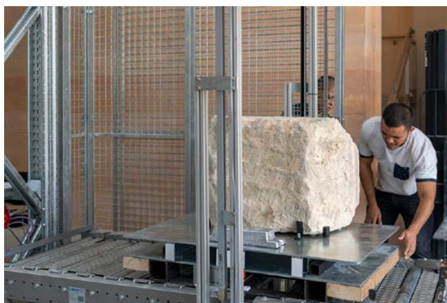
Le transstockeur amène au centre du dispositif le bloc lapidaire que le médiateur souhaite présenter au public. © Philippe Chancel / Foster+Partners - Studio Adrien Gardère - Agence Capia
