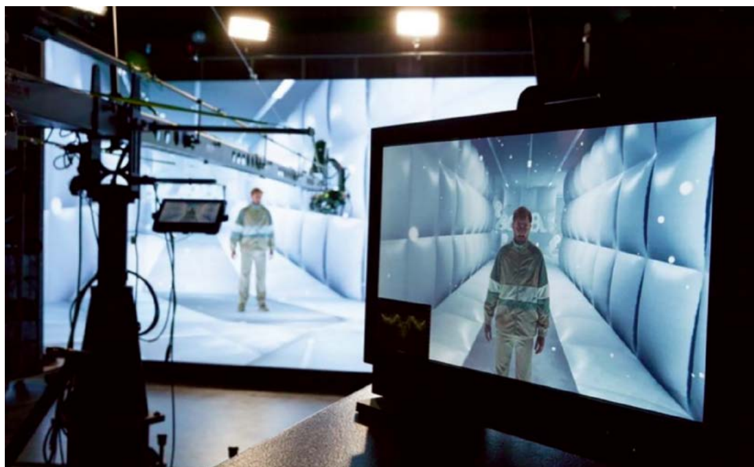
Pure View s'affranchit des méthodes traditionnelles d'incrustations sur fond vert en utilisant en arrière plan des écrans Led.
