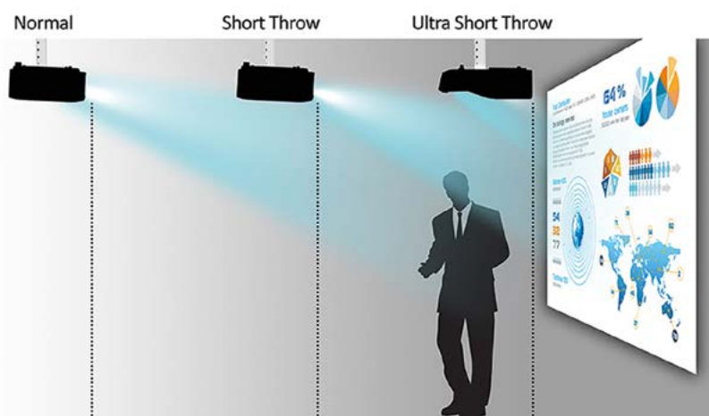
Illustration du positionnement des différents types de projecteurs selon le ratio de leur optique : focale normale en fond de salle, courte focale au milieu, ultra courte focale au pied de l'écran.
