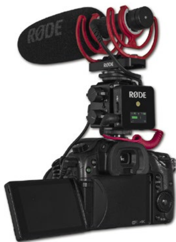
Config audio légère pour DSLR comprenant le mixeur passif Beachtek DXA-GO qui accueille ici un ensemble Rode comprenant le micro Videomic NTG et le petit récepteur Rode Wireless Go.
