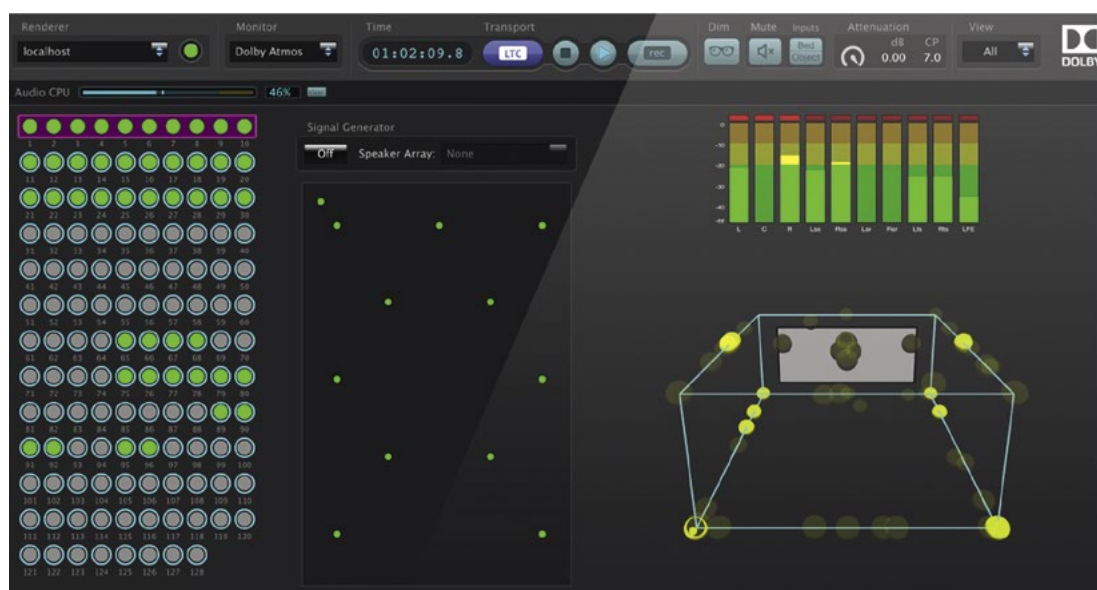
Le logiciel Atmos Mastering Suite s'ajoute à la solution Pro Tools avec une gestion fine des objets de façon individuelle et dans l'espace.
