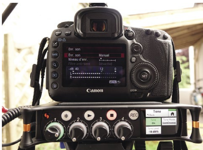
Enregistreur Sound-Devices MixPre-6 et Canon 5D Mk II : un duo adapté au tournage sur pied ou monopode et indispensable sur les DSLR d'ancienne génération dont les fonctionnalités audio étaient inadaptées au tournage. © Benoît Stefani
