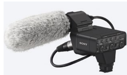
Le module audio Sony XLR K3M tire son alimentation du boîtier photo qui reçoit en échange les canaux audio via la griffe hot-shoe des appareils photos Sony compatibles.
