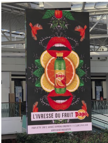
Écran Led double face pivotant de 33 m 2 en 3,9 mm HB au centre commercial Westfield Carré Senart.
