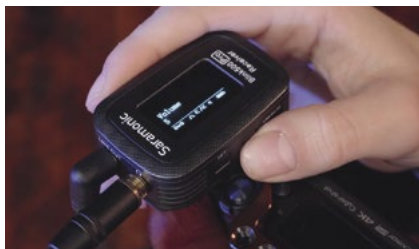
Le nouveau récepteur double Saramonic Blink 500 Pro apporte un niveau de sortie ajustable, une prise casque et un mode stéréo permettant d'assigner chaque micro sur des pistes différentes.
