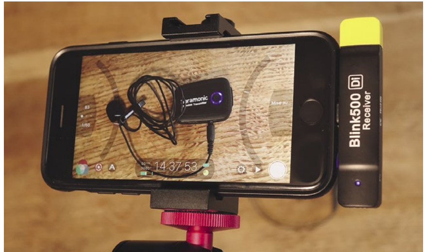
Le récepteur double Saramonic Blink 500 ici dans sa version Lightning : pas de sortie casque ni de niveau réglable mais une compacité bien adaptée au smartphone et un fonctionnement « plug and play ». © Benoît Stefani
