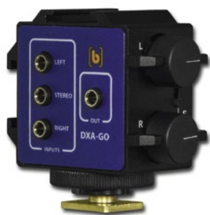
Le petit mixeur passif Beachtek DXA-GO : deux atténuateurs de niveau, deux entrées en mini-jack pour le micro et un récepteur, une sortie pour l'appareil photo ainsi que deux fixations format griffe flash.
