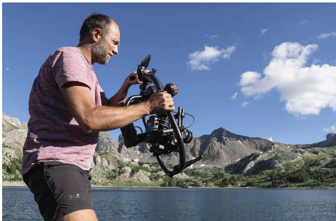
Les stabilisateurs, qui permettent des travellings faciles et fluides, enrichissent nettement les possibilités de prise de vue en mouvement. © Aurélie Gonin
