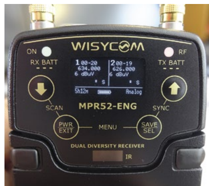
Le Wisycom MPR 52 ENG, un récepteur double compact adapté aux caméscopes de poing. © Benoît Stefani
