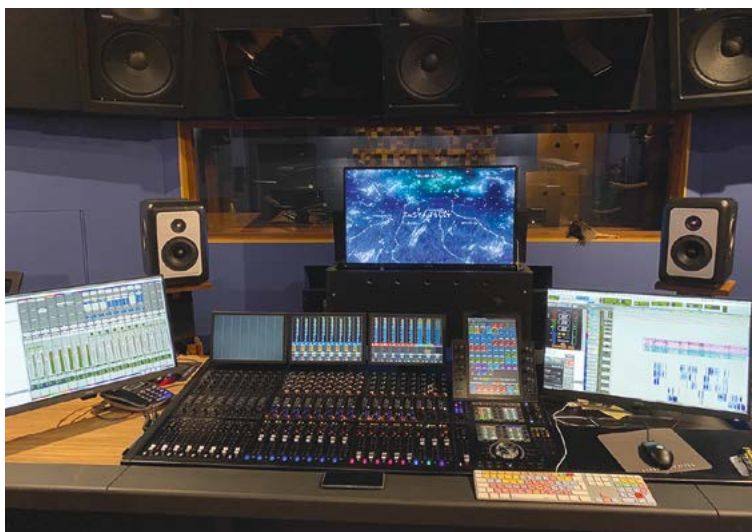
Studio d'enregistrement avec une grande cabine, et mixage équipée d'une surface de mixage Avid S6 M40.
