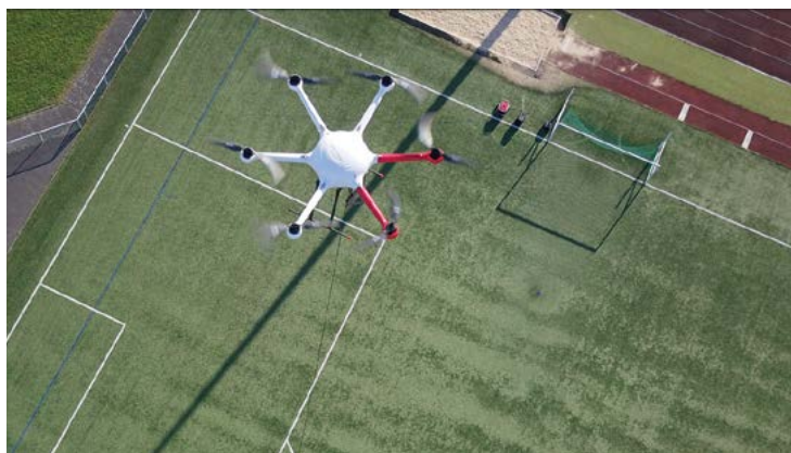
Le drone Captif de XD Motion alimenté par sa fibre peut rester en vol pendant toute la durée de l'événement, jusqu'à 100 m de hauteur.
