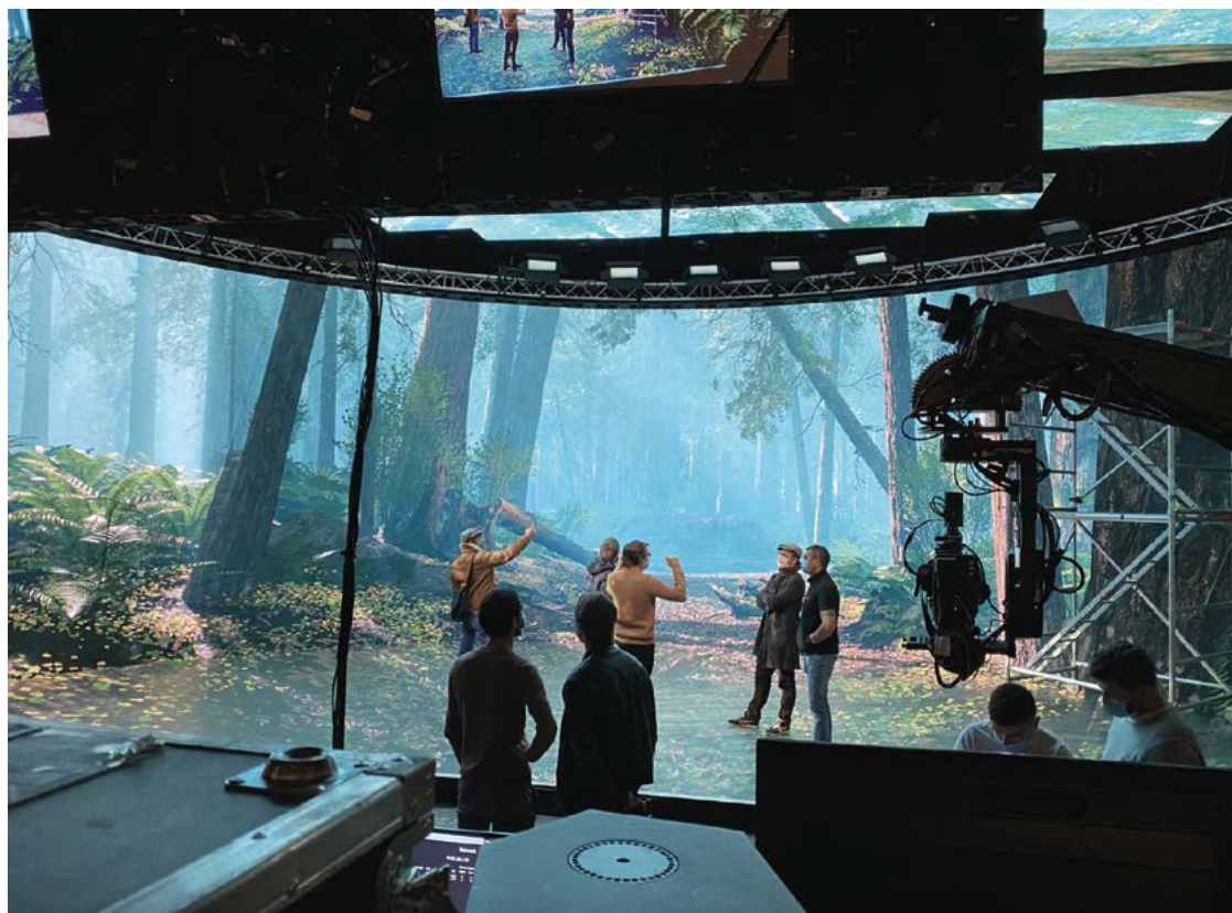
La technologie de studio XR avec fond Led, notamment ici avec un sol et plafond également équipés de Leds permet une immersion totale.
