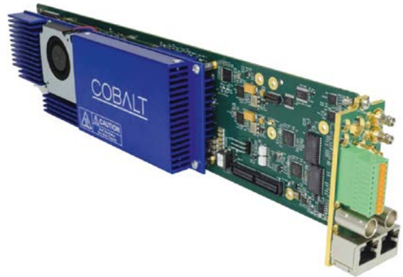
Cobalt est l'un des premiers constructeurs à proposer des équipements compatibles RIST comme ici un encodeur 4K H.264 et H.265. © Cobalt
