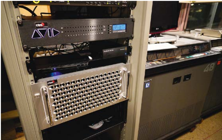
Deux générations de technologie, la nouvelle avec le Pro Tools MTRX et le nouveau Mac Pro et celle plus ancienne, les enregistreurs multi-pistes DASH 48 pistes Sony.
