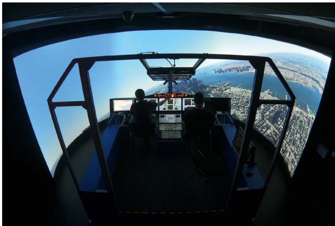
Le tout nouveau simulateur de l'ONERA, baptisé Schemax, comprend un écran composite cylindrique sur mesure de 5 mètres de diamètre sur 2,7 mètres de haut, doté de six panneaux assemblés sur place. © Avec l'aimable autorisation de l'ONERA
