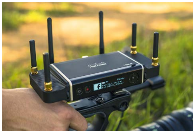
Le Teradek Vidiu est un encodeur de streaming portable à fixer directement sur la caméra. Il transmet le flux vidéo en mode sans-fil soit par wi-fi ou via des modules optionnels 4G. © Teradek
