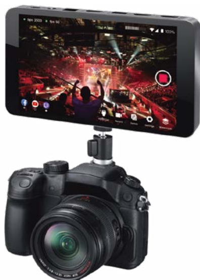
Le boîtier de la YoloBox est muni de filetage au pas Kodak pour la fixer sur un porte accessoires de caméra ou de reflex. © YoloLiv
