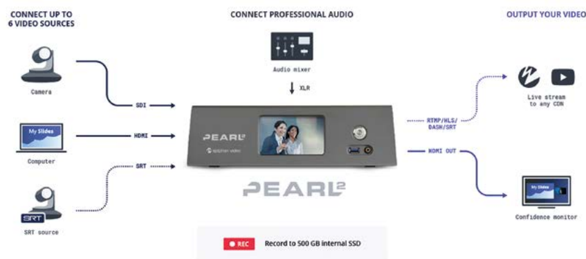
Schéma synoptique des raccordements de la station Pearl 2 d'Epiphan. © Epiphan
