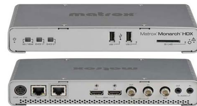
Grâce à ses deux circuits de traitement, l'encodeur Monarch HDX de Matrox accepte en entrée un signal SDI ou HDMI qu'il encode en H.264 dans deux résolutions ou débits différents. Il dispose aussi d'un enregistreur sur carte SD ou clé USB. © Matrox
