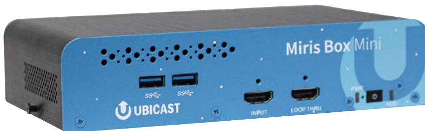
La station de production « live » Miris Box Mini d'Ubcast est équipée d'une entrée HDMI avec reprise pour diffusion sur grand écran, de ports USB pour caméras et supports de stockage amovibles. © Ubcast
