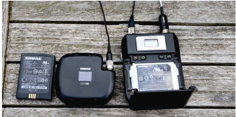
En haut : De gauche à droite, les émetteurs ceinture ADX1M et ADX1 côte à côte : noter l'accu propriétaire différent sur les deux modèles.
