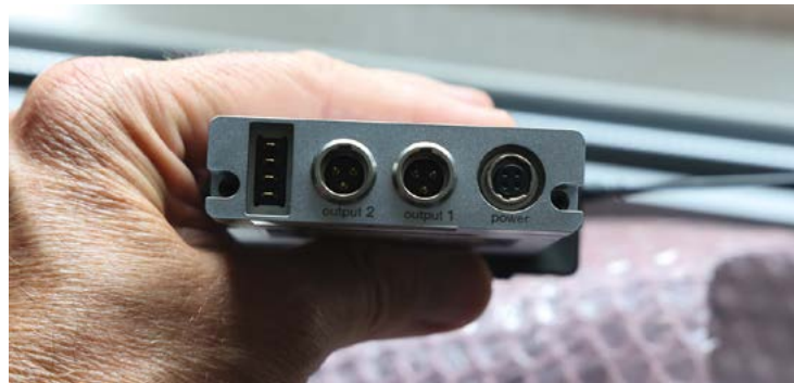
Gros plan sur le panneau arrière adapté à l'utilisation en sacoche : les deux sorties audio sur mini XLR TA3 (analogique micro/ligne ou numérique AES3) et une entrée Hirose pour l'alimentation externe qui devra fournir une tension comprise entre 6 et 18 V. © Benoît Stefani
