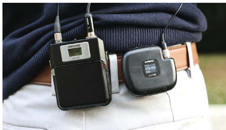
En haut : De gauche à droite, les émetteurs ceinture ADX1M et ADX1 côte à côte : noter l'accu propriétaire différent sur les deux modèles.
