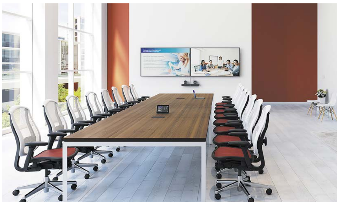
L'équipement classique d'une salle en visioconférence comprend deux grands écrans, une ou deux caméras et une unité de traitement et de communication, le codec. © Poly
