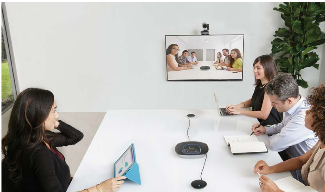
Pour les petites salles, Logitech a conçu l'outil Group comprenant une caméra et une station audio se raccordant sur un ordinateur qui fait office de codec. © Logitech
