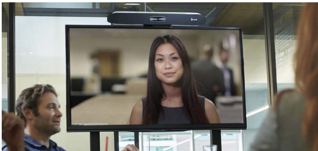
Les constructeurs ont conçu des systèmes entièrement intégrés pour les petites salles de réunion. Le modèle X50 de Poly regroupe la caméra vidéo, une barre de son et le codec. Il suffit de lui ajouter un grand écran LCD. © Poly
