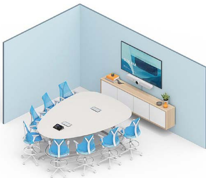
L'équipement classique d'une petite salle collaborative comprend un grand écran LCD, une barre audiovisuelle avec caméra, micros et haut-parleurs et une tablette tactile sur la table si l'équipement de visioconférence est installé de manière permanente. © Logitech
