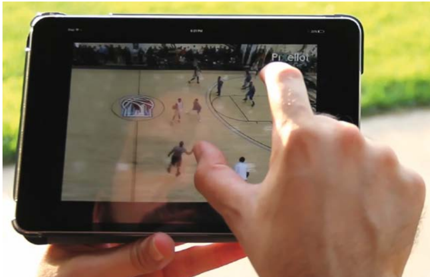
C'est grâce aux images 8K de ses caméras que le système Pixellot peut proposer aux utilisateurs de son application de live en HD de ne suivre qu'un des joueurs de la compétition sportive, sans détérioration de l'image. © Get-Live
