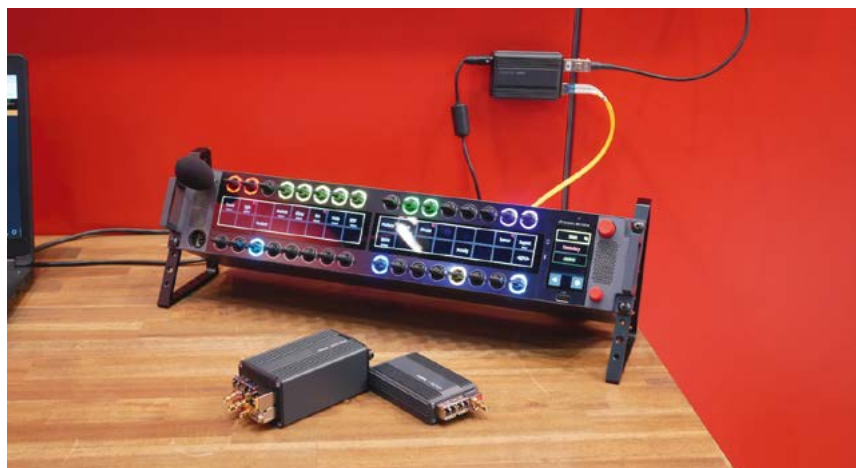
Les boîtiers interfaces Fusion reçoivent au choix des modules SFP pour FO compatibles ST-2110 et des entrées/sorties SDI ou HDMI pour faire office de passerelles entre les deux univers. © PA Taufour
