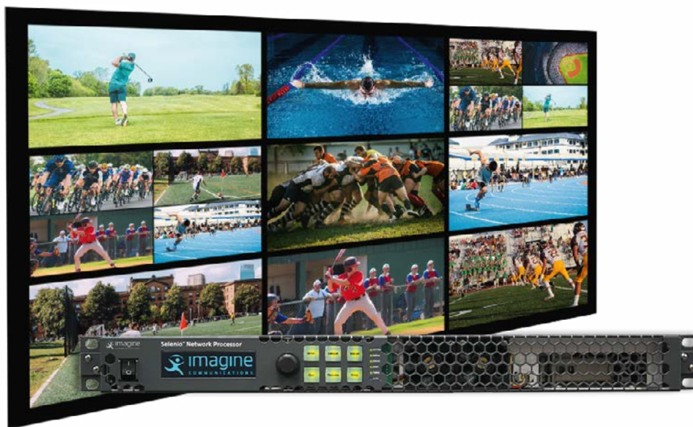
Chaque SNP occupe 1 U et est équipé de quatre processeurs indépendants, chacun ayant huit chemins de traitement 3G possédant une « personnalité » logicielle propre, prête à n'importe quel usage.
