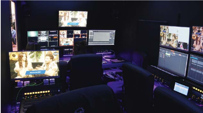
Vue intérieure du nouveau car régie de Boîte à Outils Broadcast avec au fond le poste de réalisation. © PA Taufour
