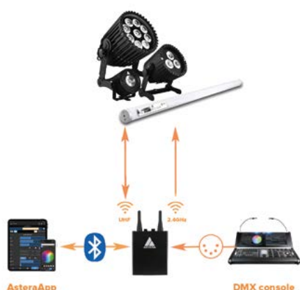
Synoptique qui explique la gestion des projecteurs ou tubes Astera, via une application ou une console DMX.
