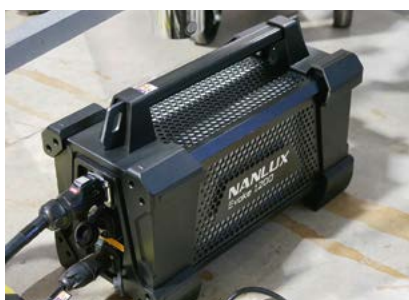
Le ballast est dissocié de la tête comme pour un HMI ce qui permet de minimiser le poids et l'encombrement.
