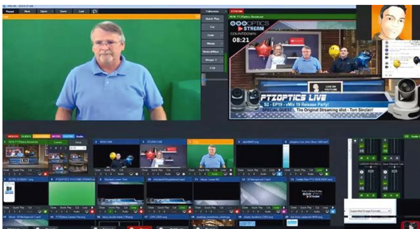
L'interface des logiciels de mixage vidéo s'affiche sous forme de module avec les deux fenêtres principales affichant les sorties « preview » et « programme », les diverses sources en mode vignette et modifiées selon les réglages choisis en entrée et leurs effets, et au gré des besoins les modules de gestion du DVE, le mixage audio et les départs de streaming. Ici l'interface du logiciel vMix. © vMix
