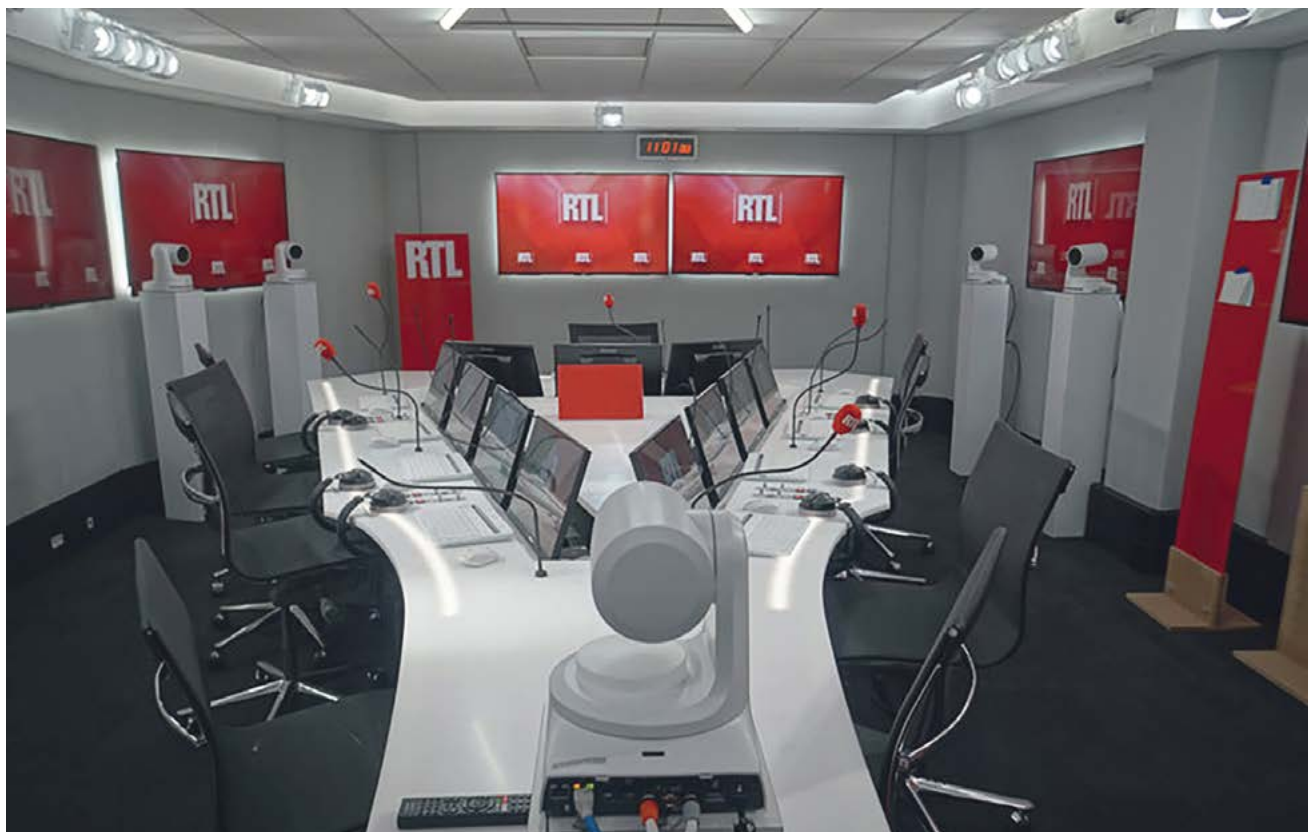
Lorsque l'espace est compté pour la mise en place d'un plateau multicam, le choix de caméras à tourelle PTZ constitue une solution adaptée. Pour des émissions au contenu organisé et maîtrisé, un cadreur unique pourra toutes les contrôler depuis la régie. © BCE
