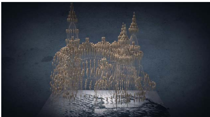
La maquette inversée en fils et poids. © Gedeon Programmes
