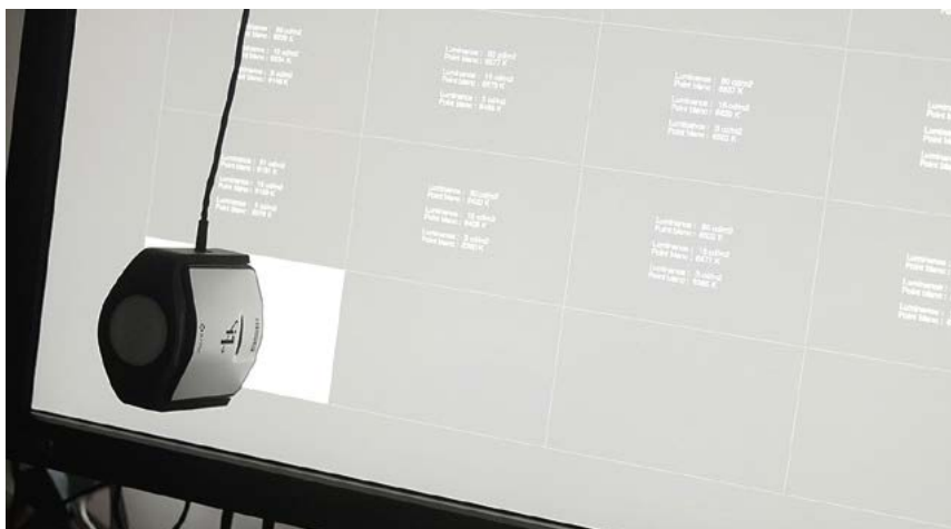
Contrôle de l'uniformité de luminance d'un écran avec la sonde Calibrite ColorChecker Display Plus. © Pascal Despeaux
