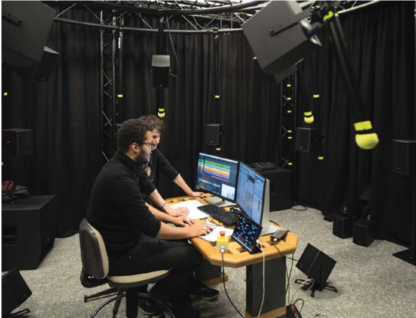
Le poste de travail se situe au point d'écoute idéal au centre du dôme de 21 enceintes avec quatre subwoofers aux quatre coins de la pièce.
