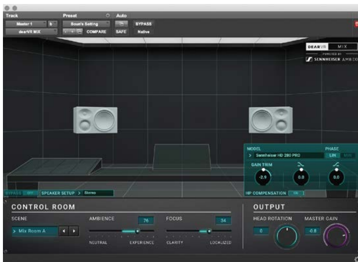
Le plug-in Dear VR Mix de Sennheiser : un produit limité à la stéréo et sans personnalisation mais qui reste particulièrement abordable. Il intègre de nombreuses courbes de casque (ici le Sennheiser HD 280 Pro), trois virtualisations de studio de mix (baptisés A, B et Analytic Dry) et six espaces acoustiques (de la cuisine au stade) pour une éventuelle vérification.
