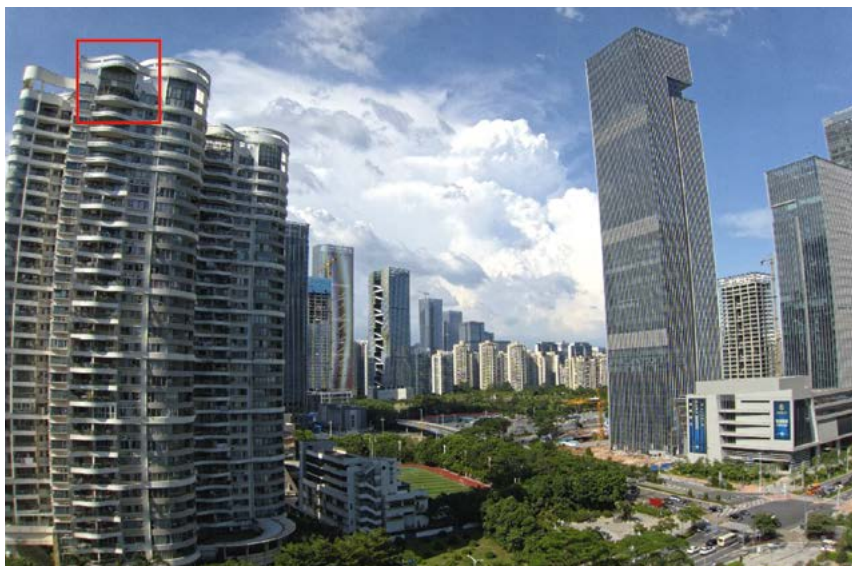
Aberration chromatique latérale, traitée comme la distorsion à correction de distorsion spécifique pour chaque canal rouge-vert-bleu. © DXOMARK
