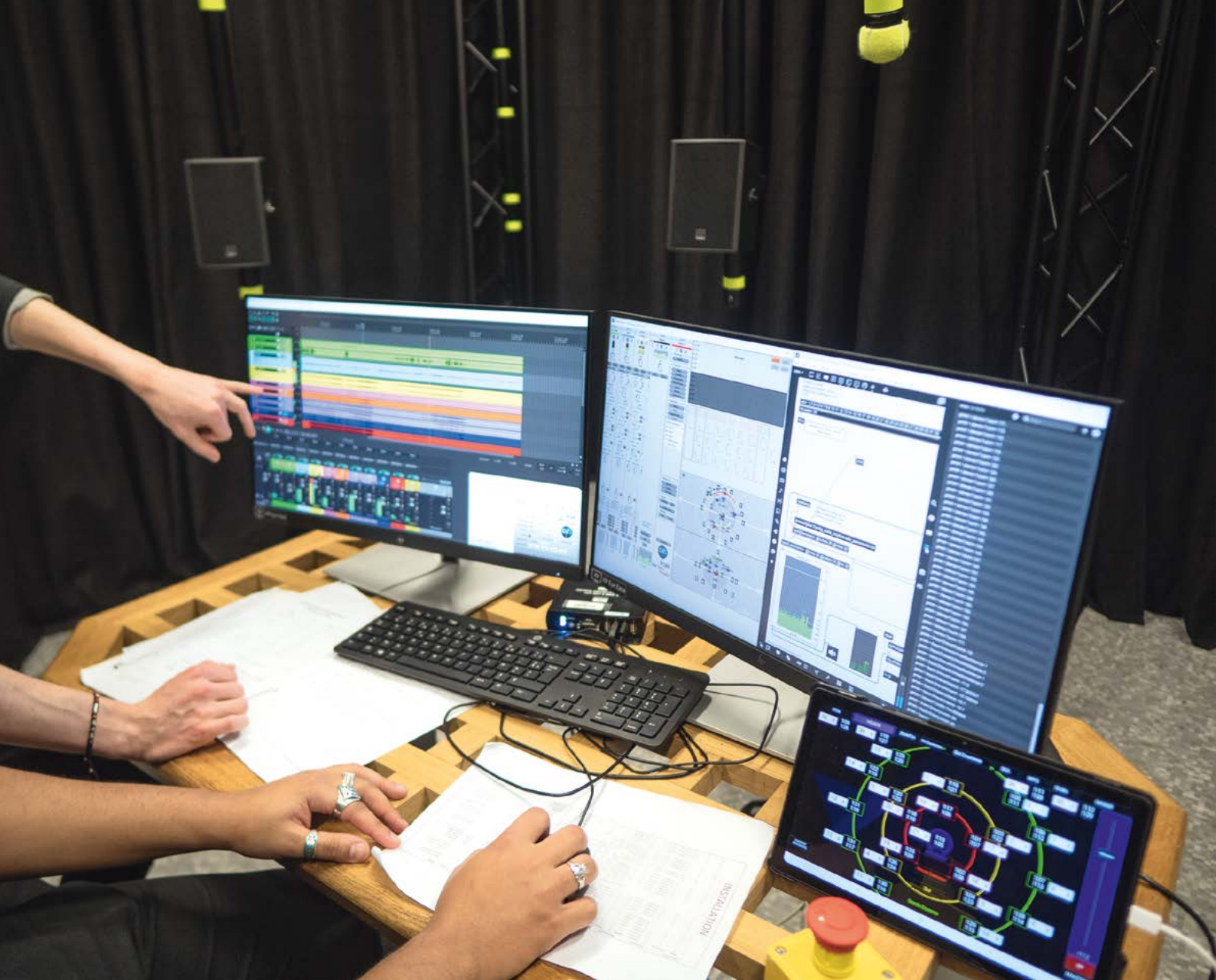
Sur l'écran de gauche, le logiciel Reaper pour importer et gérer les sources audio. Sur l'écran de droite, l'outil Panoramix de l'IRCAM pour de mixer et spatialiser les matériaux sonores. La tablette permet de contrôler le DSP Xilica.
