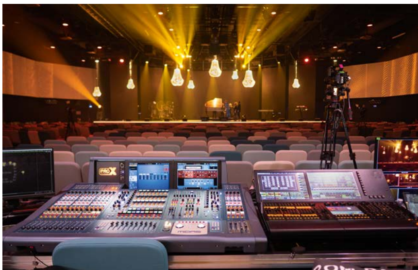
L'auditorium de 1 000 places et sa régie live. Pour le son : une console Midas Pro X pilote un son objet multicanal de 64 canaux répartis sur 73 enceintes. © Luc Bara
