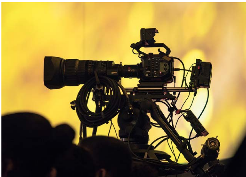
Pour une image « cinéma », l'EVA1 de Panasonic équipée d'un zoom broadcast Fujinon 42x et d'un adaptateur PL de IBE Optics. © Luc Bara
