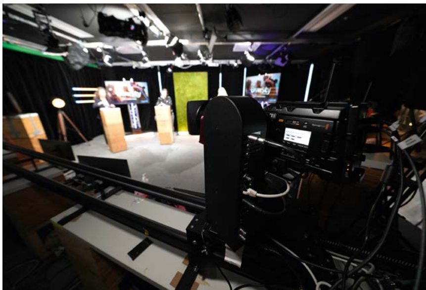
La famille de têtes robotisées, travelling et colonne télescopique Spirit de Multicam couplée au logiciel de pilotage Multicam Pilot permet d'optimiser les tournages.
