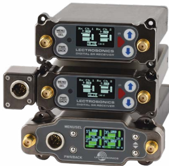
Équivalent numérique de la série SR, les récepteurs numériques DSR sont disponibles en version deux canaux (en haut), deux canaux avec sortie sur le dessus (au milieu) et quatre canaux (en dessous).
