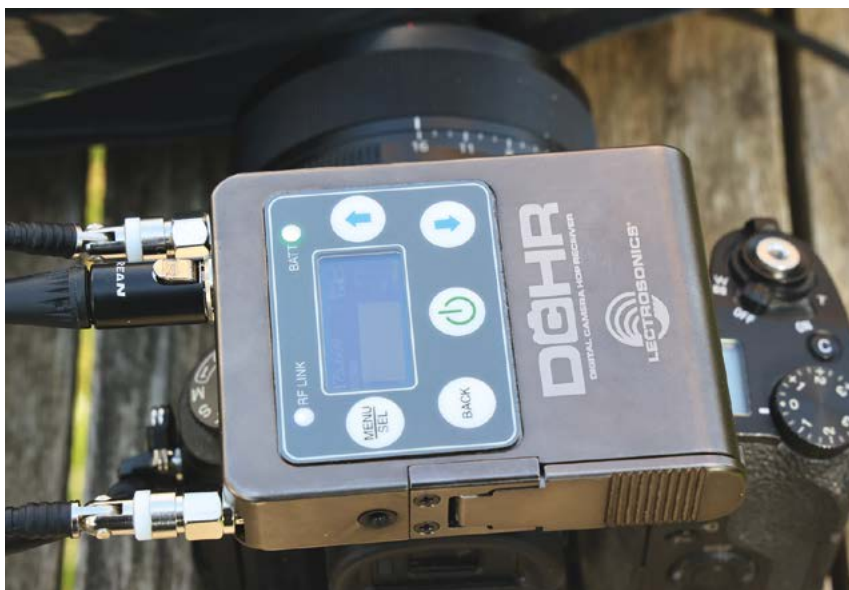
Le récepteur portable DCHR : suffisamment compact pour prendre place sur un appareil photo.
