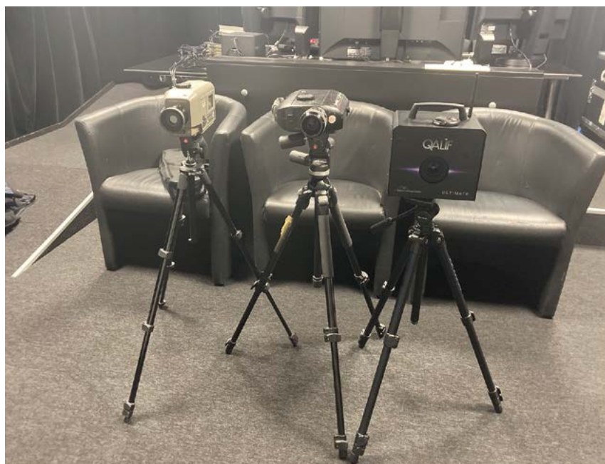
Photomètre chromamètre Konica Minolta CS 200 PR, spectromètre photo research PR 670 et Qalif Ultimatte de la CST. © CST
