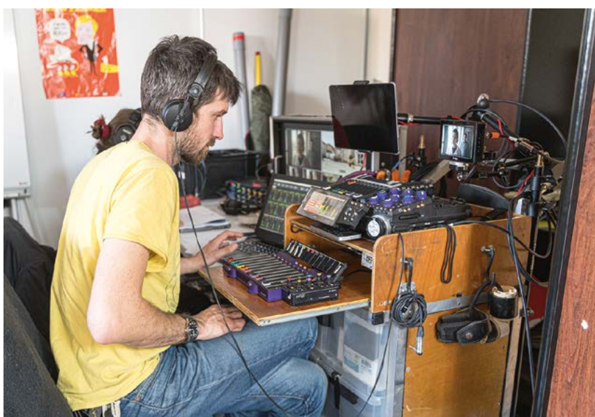
L'ingé son fiction effectue un premix des micros au moyen d'un Cantar. Un second ingé son live produira le mix final avec une console Calrec. © Alexandrine Pichot
