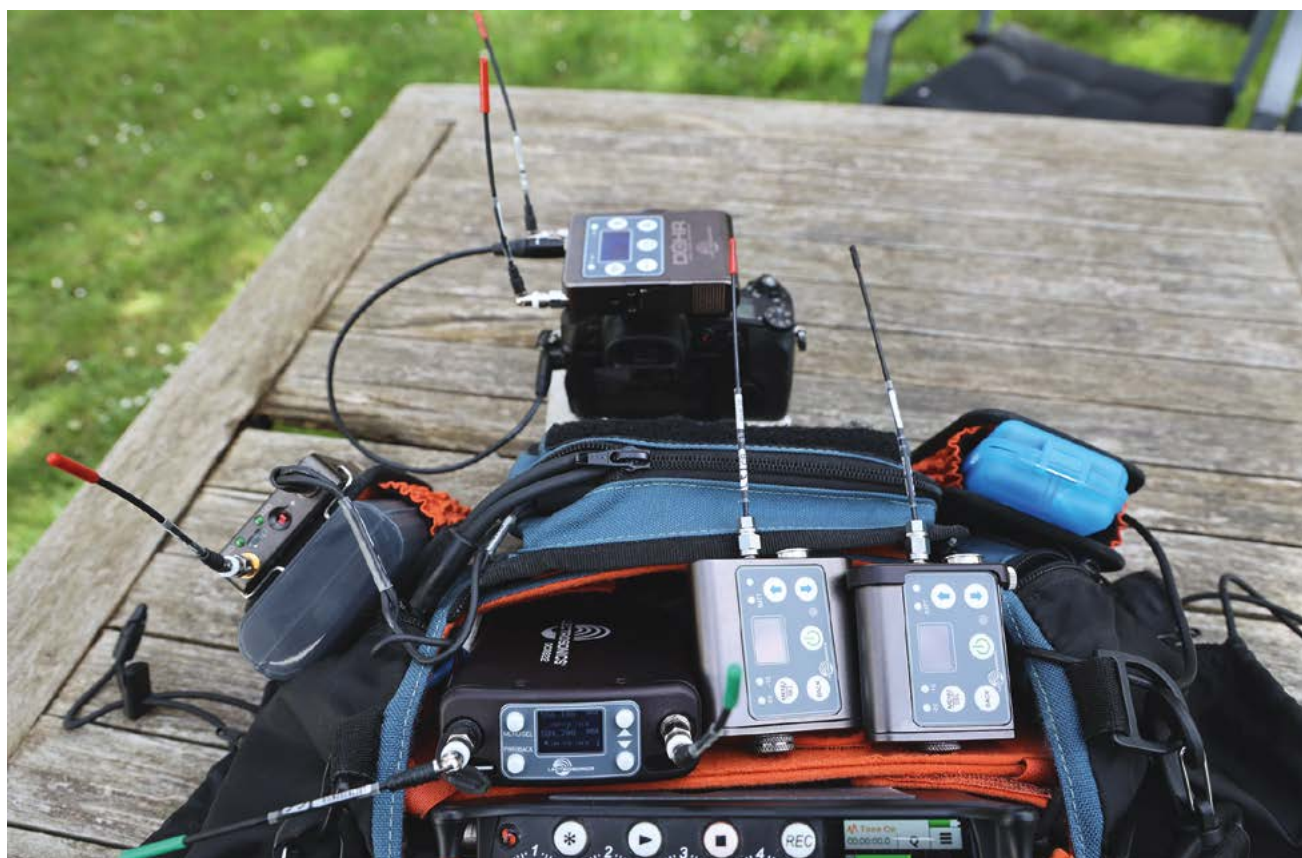
Une configuration Letrosonics full digital plutôt compacte comprenant dans la sacoche, le récepteur UCR 822, les émetteurs ceinture DBSMD (double pile) et DBSM (simple pile), le système Digital Camera Hop permettant d'assurer la transmission de deux canaux audio vers l'appareil photo numérique.
