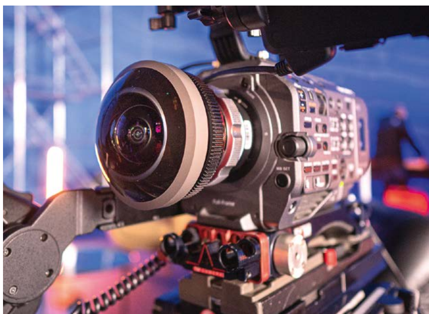
L'optique HAL 220, de la marque japonaise Entaliya, utilisée pour le tournage des plates, dispose d'un angle de vision de 220°. © Luc Bara
