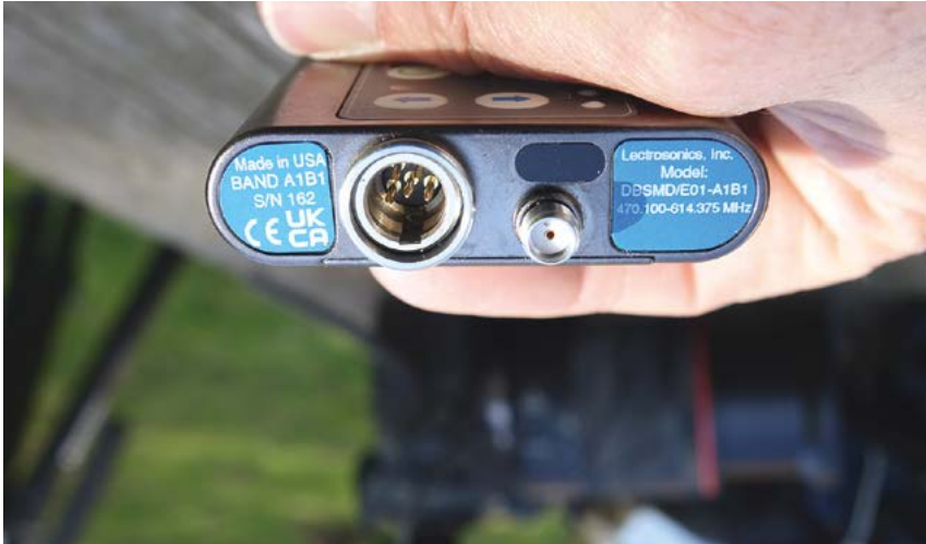
Gros plan sur les connecteurs audio (TA-3) et antenne (SMA) de l'émetteur DSMD B1 en version A1B1 (470,100 x 614,375 MHz).
