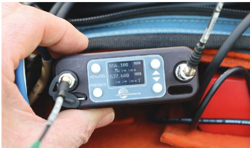
Le récepteur DCR-822. Autour de l'écran, les quatre touches permettent une navigation efficace sur l'ensemble du paramétrage du récepteur que l'on peut stocker sur micro SD (à gauche). À droite, le port IR.
