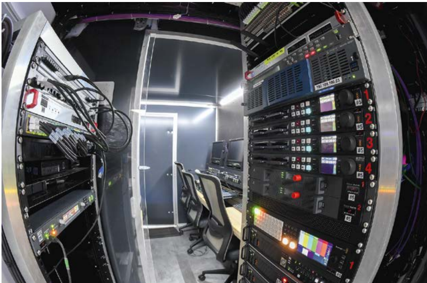
Le car est hybride IP/SDI en 4K, et toute l'ingénierie a été faite en interne. Il fait 6,5 m de long par 2,55 m de large et permet d'accueillir confortablement quatre techniciens. © Henri Goussé / Master Films
