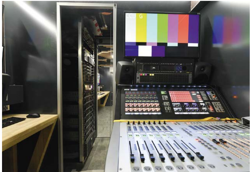
Concernant l'audio, le car est équipé d'une console numérique Soundcraft Vi1000 et est full Dante et full MADI. © Henri Goussé / Master Films
