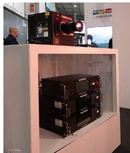
Chez Digital projection, le système modulaire Satellite MLS permet de séparer la tête de projection de la source laser Pure RGB. © Luc Bara
