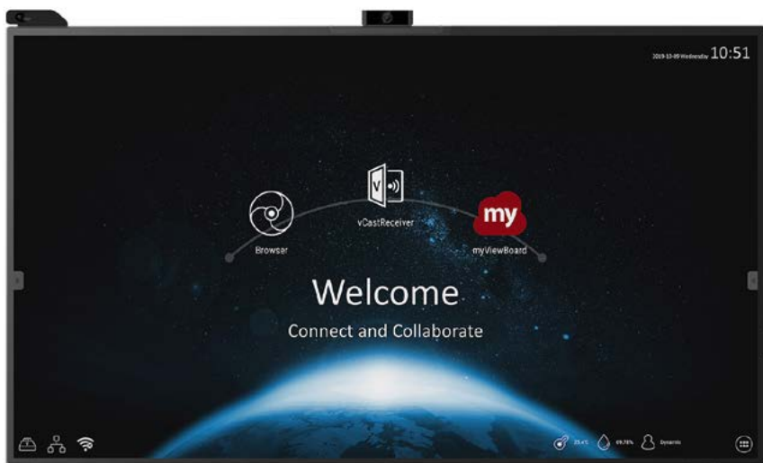
Dans sa version 86", l'écran collaboratif tactile ViewSonic IFP8670 intègre les fonctions de visioconférence grâce à une caméra et à un array de six microphones. Il dispose d'un emplacement pour un module PC enfichable. @ ViewSonic
