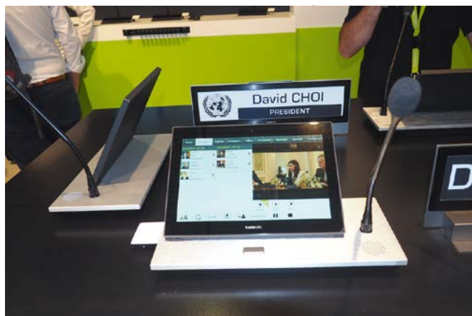
Televic nous propose un nouveau poste de conférencier pour sa gamme Flex. Celui-ci est identique pour les présidents ou les délégués, et permet aussi la position d'un micro pour deux délégués. Les boutons nécessaires à ces différentes utilisations sont totalement configurables par soft, ce qui simplifie les commandes et les stocks. © Antoine Gruber
