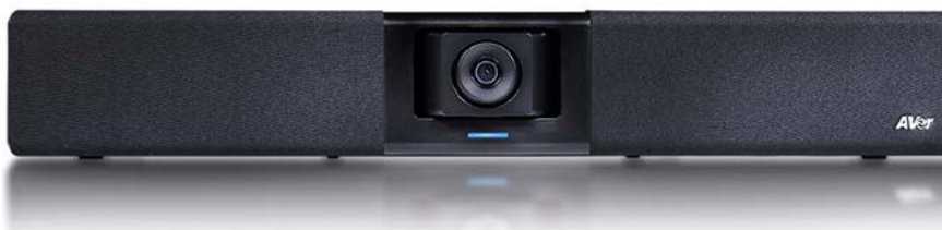
La barre audiovisuelle Aver VB342 Pro est équipée d'une caméra motorisée avec zoom optique. © Aver
