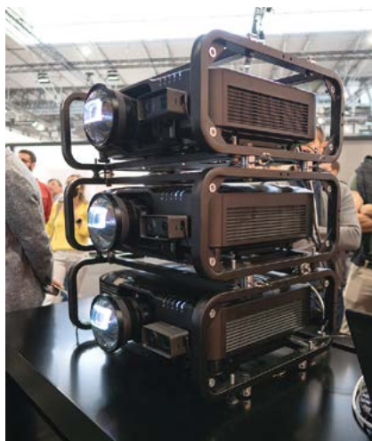
Trois projecteurs EPSON EB-EPU2010 de 10 000 lumens équipés chacun d'un module caméras ELPEC01 permettant de réaliser le stacking sans PC additionnel. © Luc Bara
