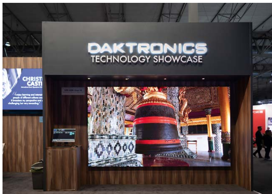
Daktronics présente plusieurs écrans all in one dans des technologies COB ou IMD. Ici le NPN 5400, un écran UHD de 3,6 m de large avec un pitch de 0,9 mm. © Luc Bara
