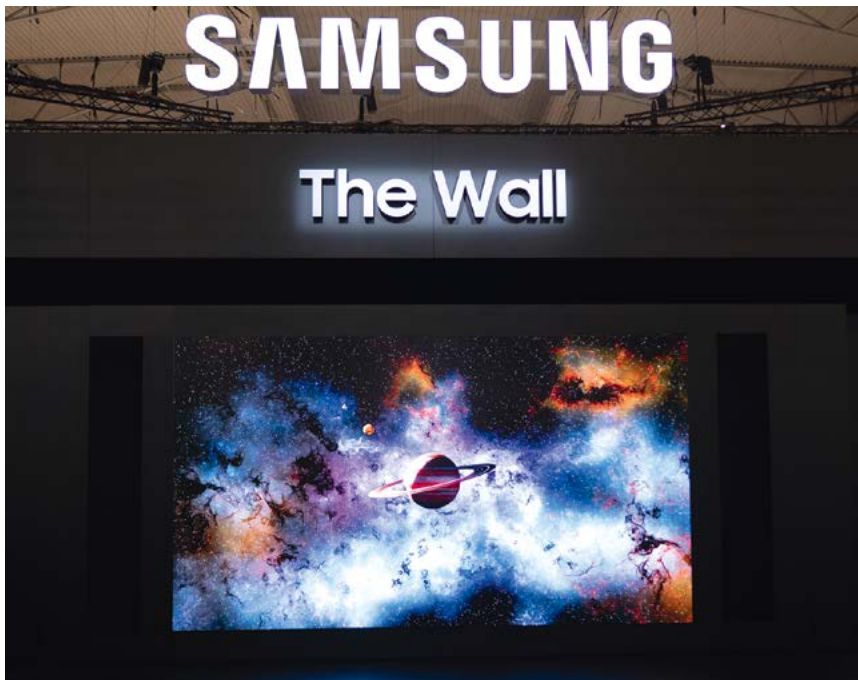
Samsung fait sensation avec The Wall, sa technologie de mur LED au pitch de 0,63 mm. L'écran présenté ici fait de 5m de large pour une résolution 8K. © Luc Bara
