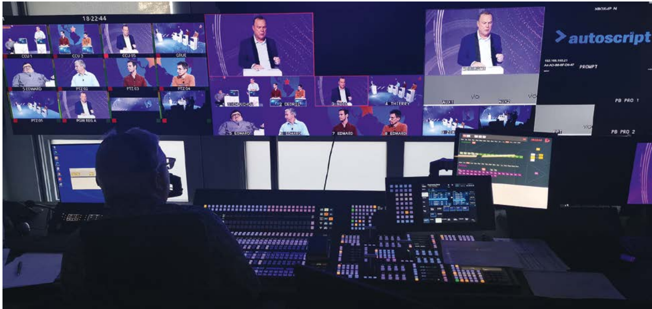
La régie A est équipée d'un mélangeur vidéo Sony XVS 6000 disposant de quatre barres de Mix/effect. © Videlio
