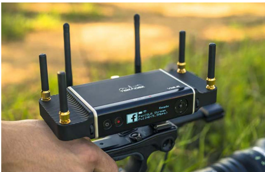
Le Teradek Vidiu est un encodeur de streaming portable à fixer directement sur la caméra. Il transmet le flux vidéo en mode sans-fil soit par wi-fi ou via des modules optionnels 4G. © Teradek
