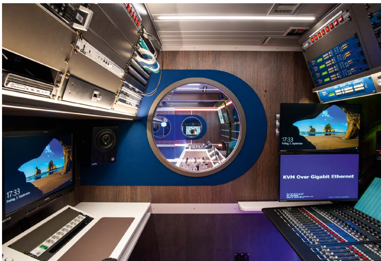
Le car-régie de Studio Berlin est équipé de multiples extenders KVM sur IP Apantac pour distribuer les signaux vers les différents postes et écrans. © Apantac
