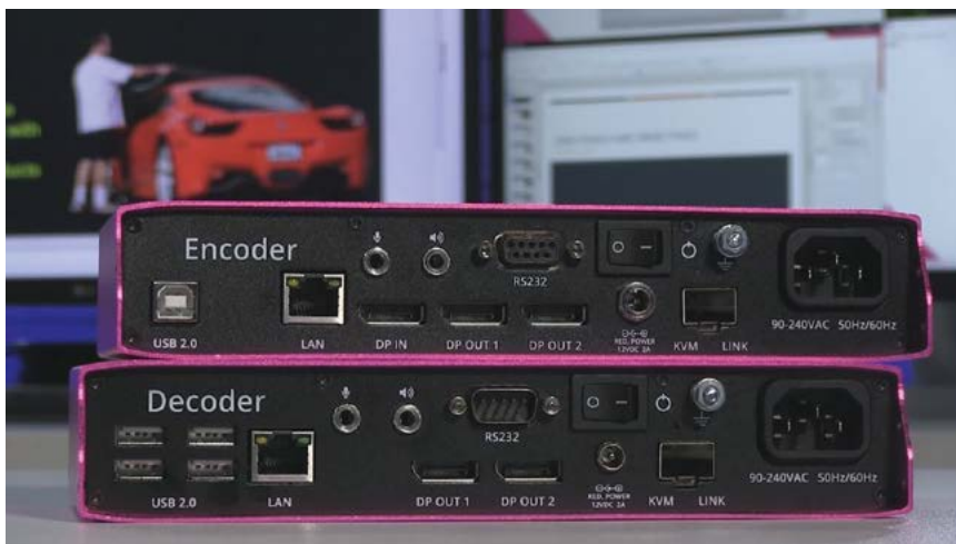
Les interfaces Magenta Pathfinder existent en deux versions, Full HD ou 4K. Dans les deux cas, elles communiquent à travers le réseau via une fibre sur emplacement SFP. @ tvONE
