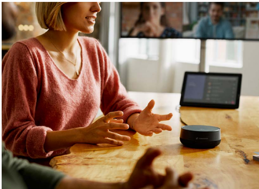
Le TeamConnect Intelligent Speaker de Sennheiser est un speakerphone évolué dont les fonctions se pilotent à la voix. Ses sept micros en beam forming sont capables de différencier jusqu'à dix voix à 3,5 mètres de distance. © Sennheiser
