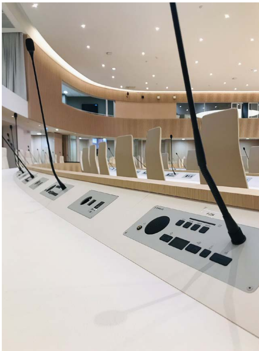
Chaque siège de conseiller est équipé avec une platine regroupant les fonctions de prise de parole et les commandes de vote électronique. Une seconde platine sert au raccordement du micro-ordinateur. © Equans
