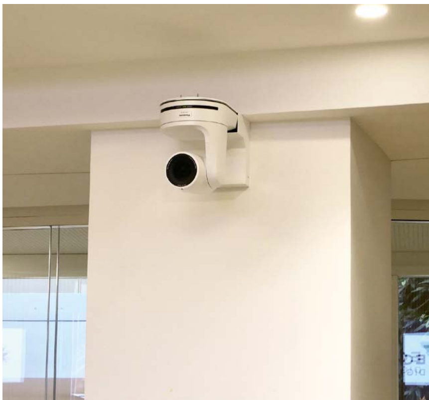
L'une des six caméras sur tourelle Panasonic servant à filmer les interventions des conseillers. Leur position et leur cadrage sont asservis à la prise de parole. © PA Taufour
