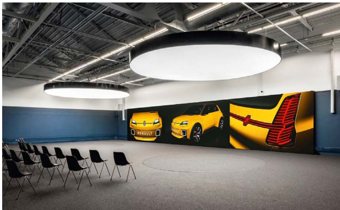
Le centre de design Renault à Guyancourt est équipé d'un large mur d'image de 16,3 mètres par 3,1 mètres de haut composé de panneaux Led Leyard avec un pitch de 1,5 millimètres. © Leyard
