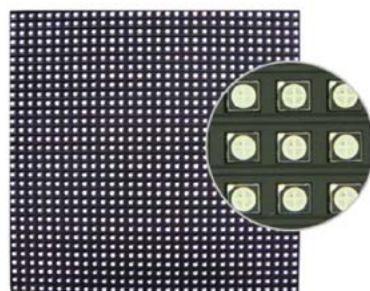
Les panneaux Led les plus courants utilisent des composants SMD comprenant les trois diodes rouge, verte et bleue intégrées. @ Keasy
