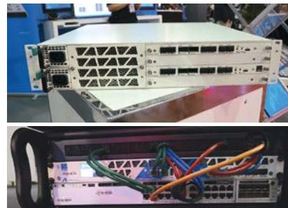
En haut : La nouvelle passerelle vidéo 2110 Lawo.Edge : jusqu'à 192 flux SDI dans un rack 2U. En bas : le nouveau A.UHD Core, dédié aux processing audio des consoles Lawo MC2 56 et 96, frappé par sa compacté : une seule unité 19 pouce contre 7 pour l'ancien modèle !
