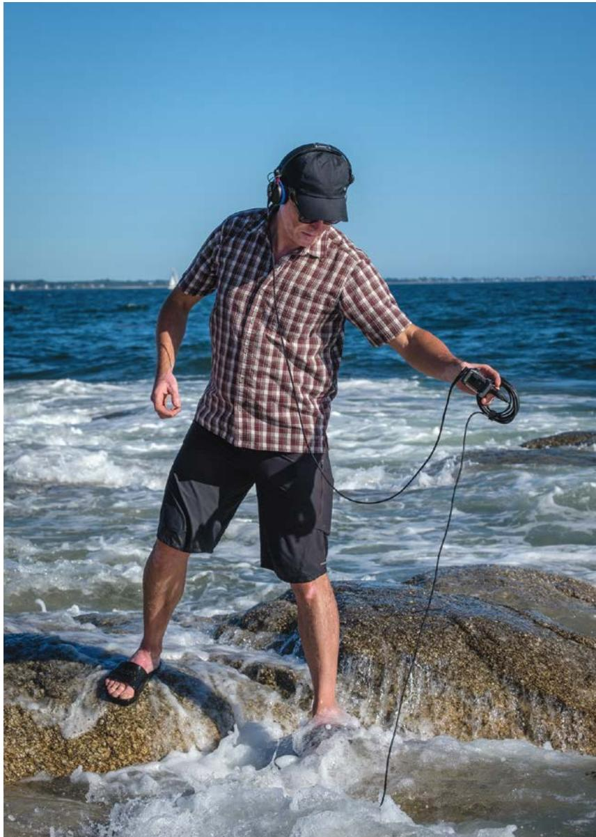
Un enregistrement de bouillon dans les vagues avec un hydrophone.
