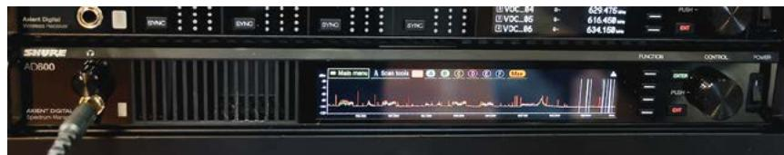
Le manageur HF Shure AD 6000 : un large écran 6 pouces pour visualiser et gérer le spectre HF de 174 MHz à 2 GHz en quasi temps réel. © Benoit Stefani
