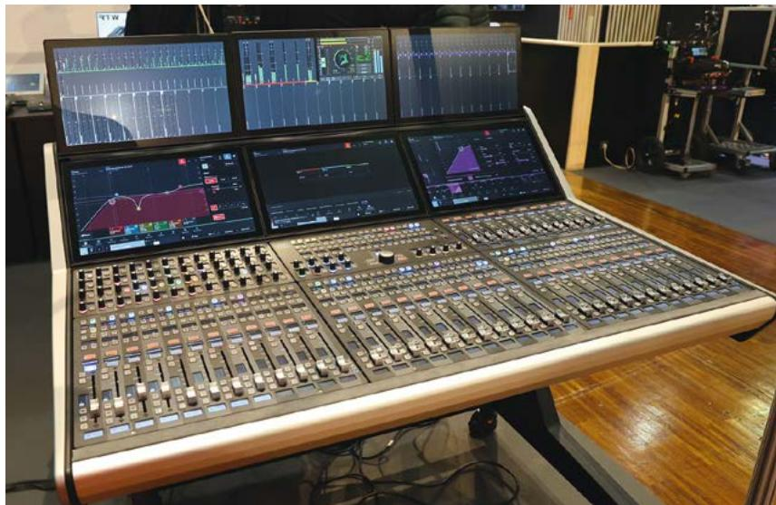
La nouvelle console numérique Argo : nativement IP/AES 67 et configurable de 12 à 240 faders, elle se distingue par la présence d'un afficheur dédié par bouton et par potentiomètre de réglage et se destine à des applications TV et radio. © Benoit Stefani
