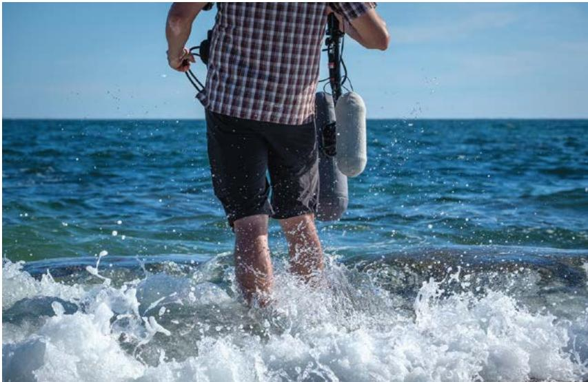
Reproduire le son des vagues qui viennent frapper les coques du bateau, tel est l'enjeu de cette prise de son de vague effectuée sur une plage, en 5.0 avec les microphones monocorps stéréo et Quad Neveton MC50 et MC550 placés sur perche.
