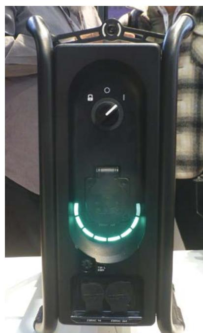
La batterie portable One Max Instagrid délivre 3 600 W en continu et supporte des crêtes à 18 000 W.
