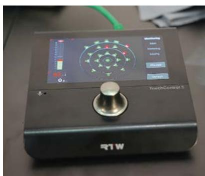
Le RTW TouchControl 5 : un nouveau contrôleur de monitoring Dante permettant de gérer des configurations allant de la stéréo au 22.2. depuis son écran tactile 5 pouces.
