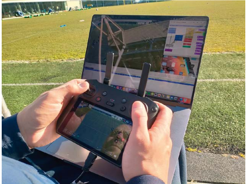
Un Smart Controller permet de visualiser en direct l'image capturée par le drone clermontois grâce à une sortie HDMI.
