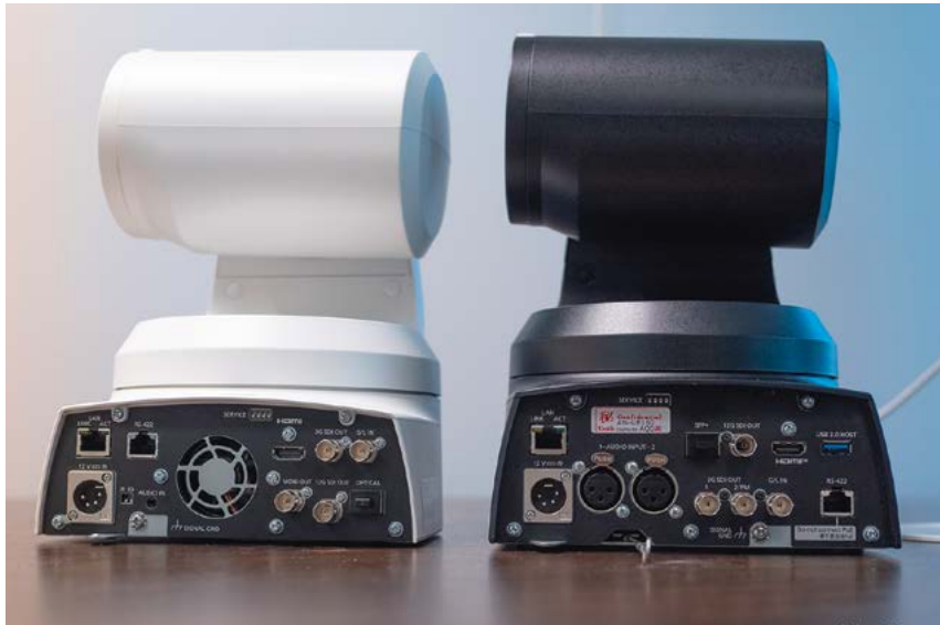
La connectique enrichie de l'AW-UE160 (à droite) comparée à celle de l'AW-UE150 (à gauche). © Luc Bara
