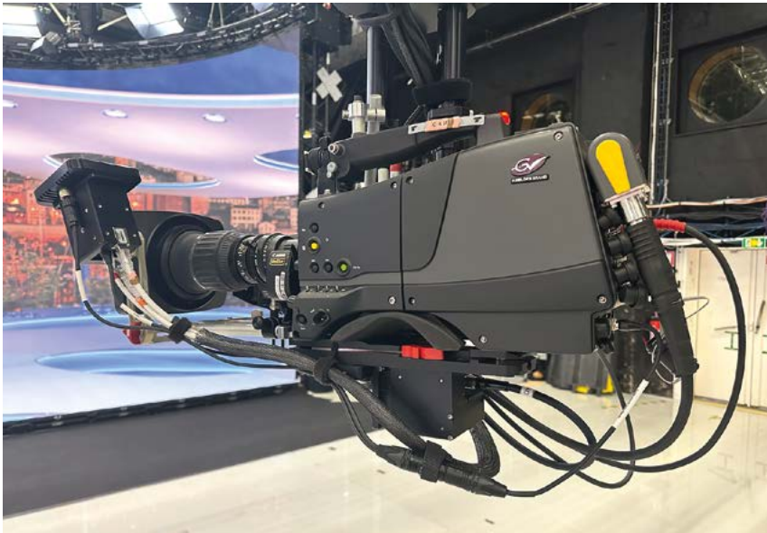
Les caméras sont instrumentées avec la technologie de tracking Trackmen pour assurer un suivi de l'image 3D sans failles.
