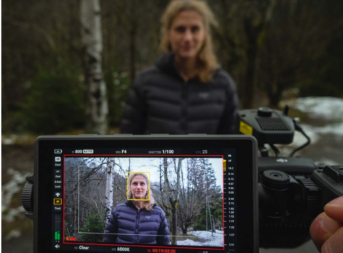
Une fois le sujet repéré et validé, il est suivi par l'autofocus et par la nacelle qui ajuste ses positions pour le garder dans le cadre.
