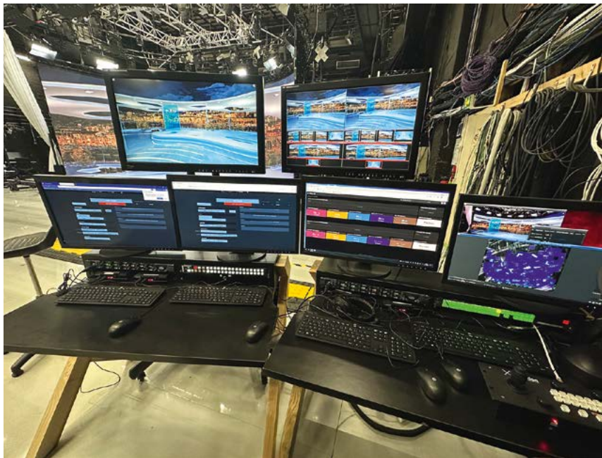
Le poste de travail pour deux personnes est le poste de commande centralisé qui permet de gérer les caméras et le décor 3D en temps réel.
