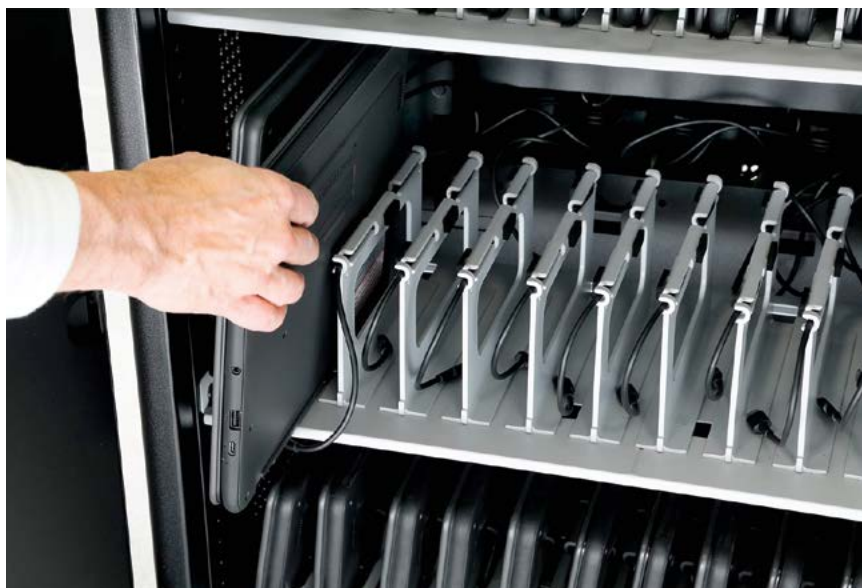
Les chariots de recharge Dell sont dédiés aux ordinateurs de la marque avec un câble de courant et, en option, une prise réseau pour les mises à jour. © Dell
