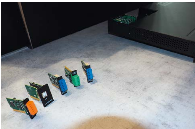
Les processeurs audio de Xilica sont modulables avec ces petits inserts, mais comportent aussi entrées et sorties Dante, et USB.
