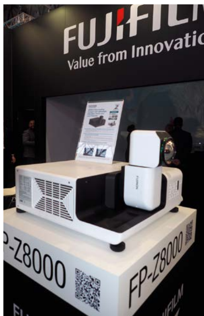
Fujinon est toujours fidèle à ses projecteurs à objectif pliables FP-Z8000 qui permettent des décentrages très importants de l'image sans déformation. © Antoine Gruber
