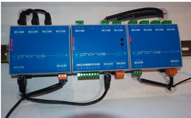
Pharos, constructeur anglais, nous présente ici un contrôleur de lumière architectural avec bus DMX et Dali dans le même boîtier.
