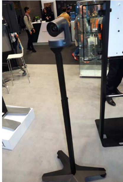
Pour les cas où l'on ne peut accrocher la caméra au mur, Erard Pro nous propose ce pied de sol réglable pour positionner la caméra au mieux. © Antoine Gruber
