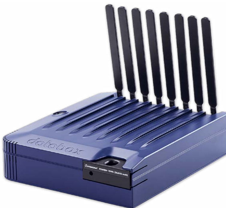
Avec ses quatre modems et ses huit antennes orientables, la passerelle Databox wi-fi/4G répartit le flux des données sur plusieurs opérateurs. © Datanaute
