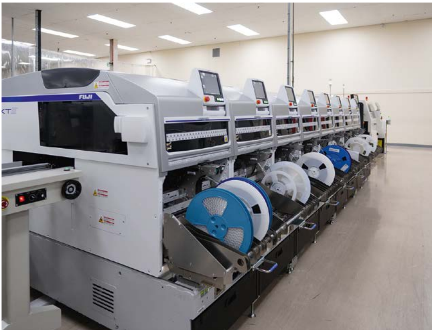
Les machines Fuji utilisées pour la pose des petits composants sur les circuits imprimés. © Luc Bara
