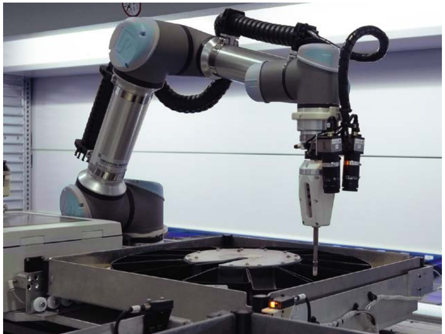
Nouveau système développé par l'équipe R&D de Pencoed en phase de test. Le bras robotisé est équipé d'une caméra stéréoscopique pour reconnaître et saisir n'importe quelle pièce d'après son schéma CAD 3D. © Luc Bara
