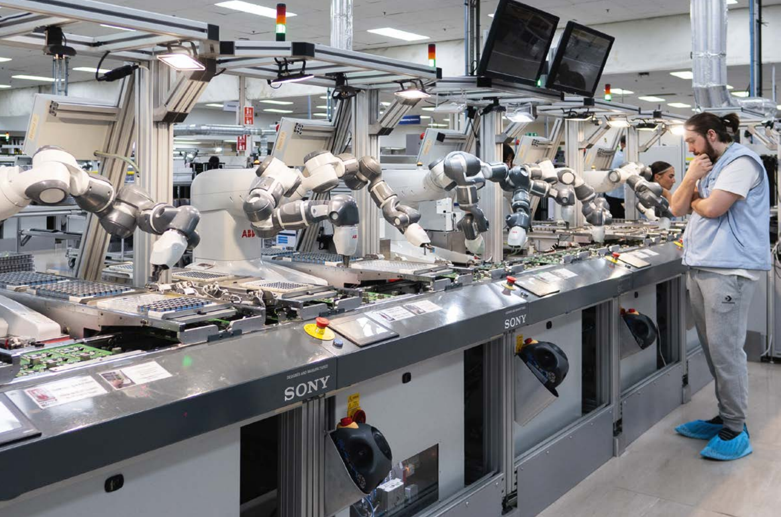
La chaîne de fabrication Raspberry Pi entièrement automatisée offre un véritable spectacle de chorégraphie où les robots ABB placent les gros composants sur les cartes. © Luc Bara
