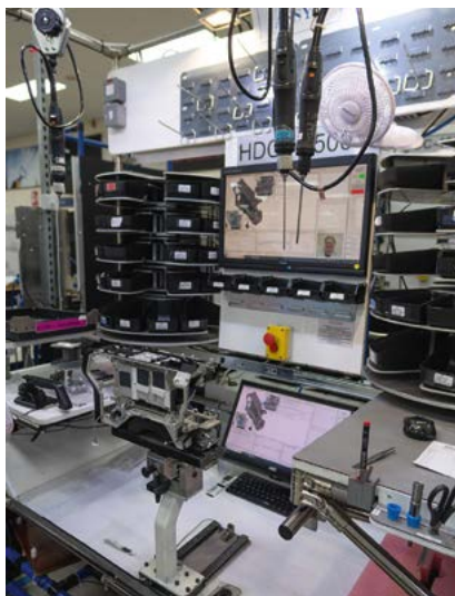
À ce poste d'assemblage une seule personne assemble de A à Z les caméras de studio de Sony. © Luc Bara
