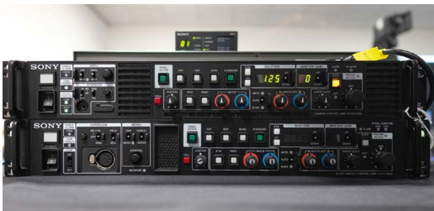
La nouvelle voie de commande HXC-FZ90 au-dessus de son prédécesseur, le HXC-FB80, et tous deux équipés d'un panneau de contrôle en face avant. © Luc Bara
