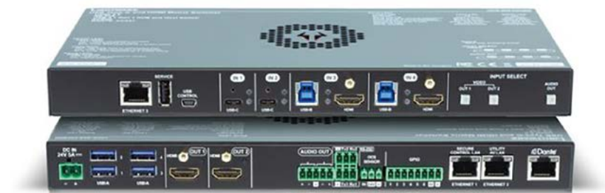
Avec ses nombreux connecteurs, le sélecteur Taurus de Lightware démultiplie les accès aux divers équipements de la salle de réunion. © Lightware
