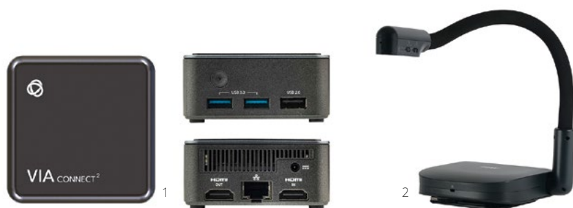
1. Le boîtier Kramer VIA Connect 2 ajoute la fonction BYOM à n'importe quelle salle de réunion grâce à l'USB partagé sans fil. © Kramer 2. Avec le visualiseur AVer U70i, on peut filmer des documents, des objets et déplacer son bras flexible pour le transformer en webcam, le tout s'intégrant dans n'importe quel logiciel de visio. © AVer
