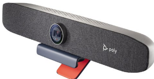
Via un faisceau de trois micros et des technologies de suppression intelligente de l'écho et du bruit de fond, la Poly Studio P15 vise une qualité sonore impeccable associée à une image en 4K.
