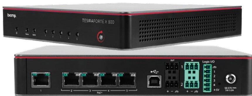
Les DSP de Biamp prennent place dans ces petites interfaces TesiraFORTH X pour gérer de quatre à seize flux via le réseau. Les ports RJ45 PoE servent à alimenter directement jusqu'à quatre équipements de la salle.
