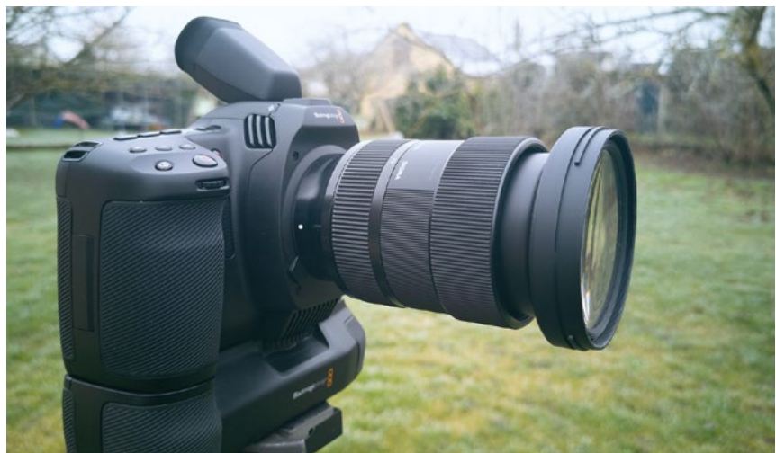
La monture L de la Blackmagic Cinema Camera 6K permet d'adapter de nombreux objectifs comme ici un Sigma Art 24-70 mm. © Loïc Gagnant
