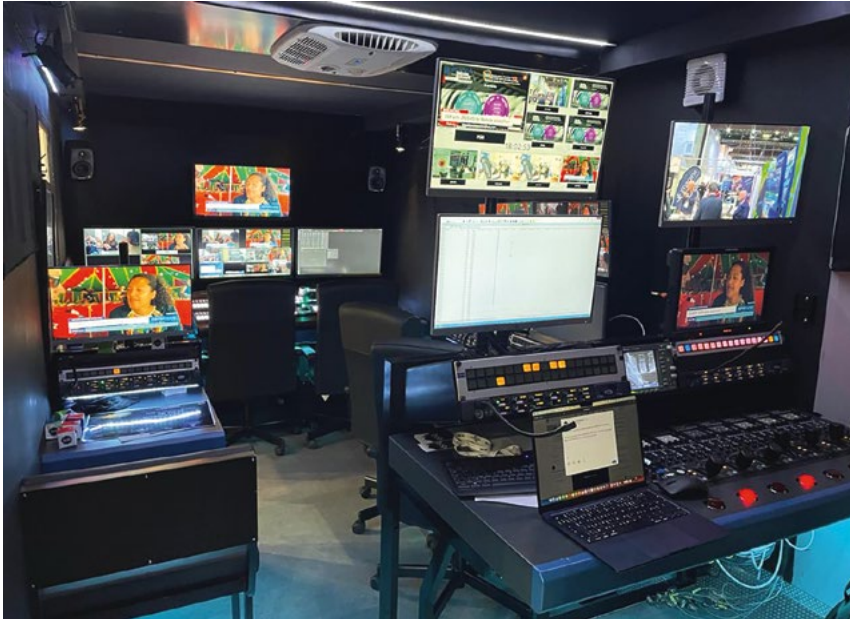
Vue intérieure du car-régie de la Boîte à Outils Broadcast. Il offre une grande souplesse car chaque poste de travail est conçu pour recevoir un équipement adapté à la production. © BOB
