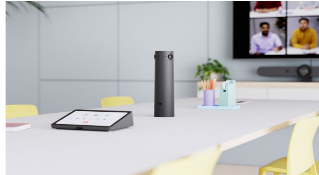
Placée au milieu de la table de réunion, la caméra Sight fournit des cadrages simultanés et rapprochés de quatre participants. © Logitech
