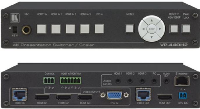
Le sélecteur/scaler Kramer VP-440H2 associe trois entrées HDMI 4K60p, une autre raccordée en HDBaseT 4K et une dernière VGA analogique HD. L'entrée sélectionnée est disponible en sortie à la fois en HDMI et HDBaseT. Il est équipé de circuits audio avec embedder/déembedder. © Kramer
