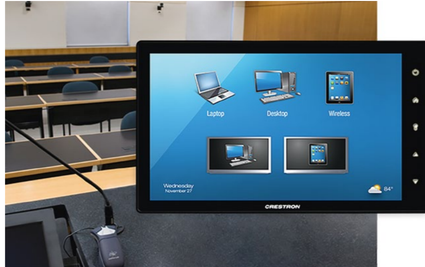
Un automate associé à un écran tactile, ici un modèle Crestron, permet de regrouper les commandes de plusieurs équipements dans une interface graphique, logique et ergonomique. © Crestron
