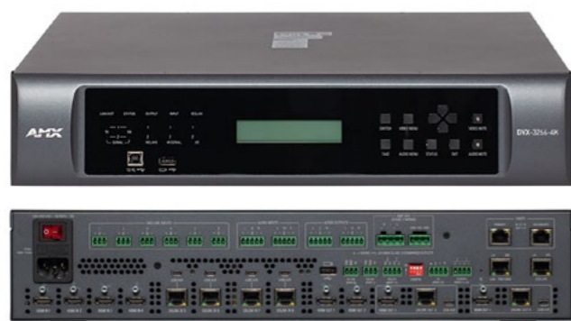
Le système de présentation AMX DVX-3266 commute huit sources 4K vers quatre destinations avec des fonctions de scaler. Il regroupe également un système de mixage audio (E/S analogiques et réseau Dante), un amplificateur de 120 W et le système d'automation de la salle. © AMX
