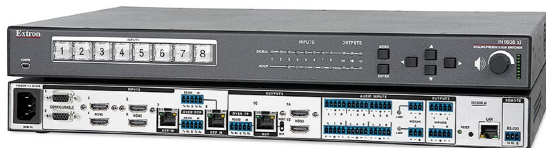
Le sélecteur/scaler Extron IN1608xi est équipé de deux entrées VGA universelles compatibles avec des sources vidéo analogiques, quatre entrées HDMI et deux sur paires torsadées DTP. Il est pourvu de deux entrées micros/ ligne mélangeables avec l'audio associé aux sources d'images. © Extron
