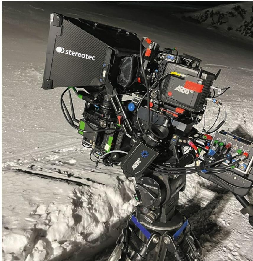
Le rig à miroir de Stereotec a servi à créer des effets intéressants pour renforcer l'effet d'obscurité tout en éclairant l'arrière champ. Sur le rig, une caméra Arri classique, et la seconde caméra était infrarouge. La combinaison des deux images donne une image finale avec du contraste.
