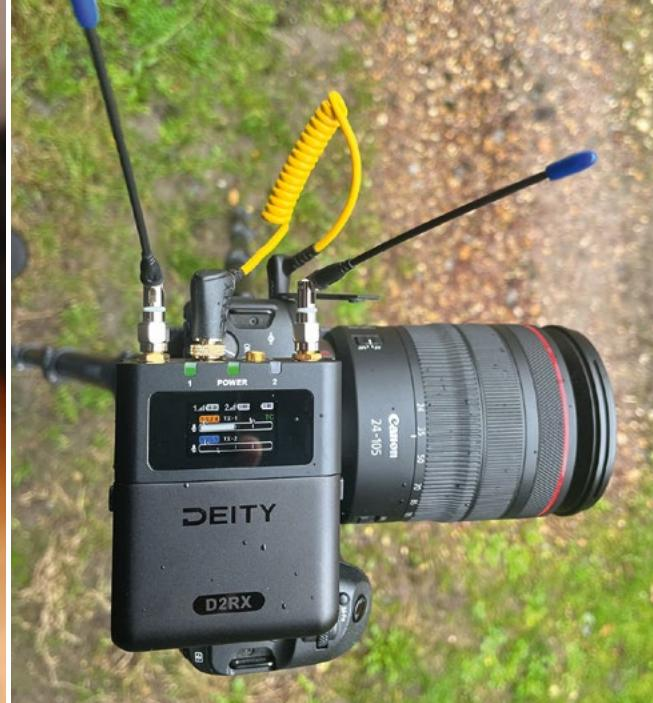
Le sabot fourni permet de placer facilement le récepteur sur un reflex numérique. La deuxième sortie permet alors d'être utilisée comme monitoring casque.
