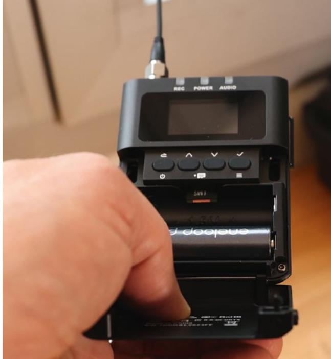
Gros plan sur la trappe à pile et le port Micro SD pour l'enregistrement direct sur l'émetteur.
