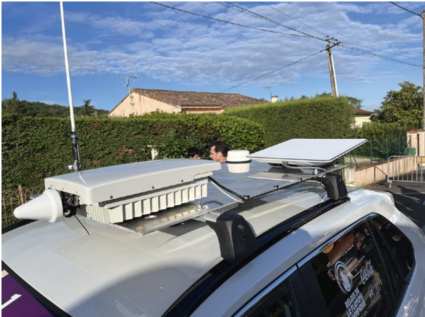
Détail des antennes de la bulle 5G, avec l'antenne 5G à l'avant (à gauche) et l'antenne satellite Starlink à l'arrière (à droite). © France Télévisions
