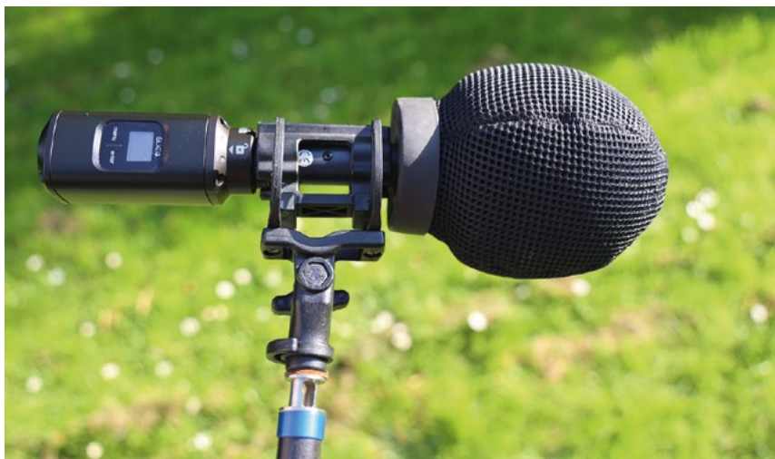
Le nouvel émetteur plug-on SLXD3 permet facilement de se construire une perche HF pour la fiction ou le reportage. Noter le système de connecteur à verrouillage.
