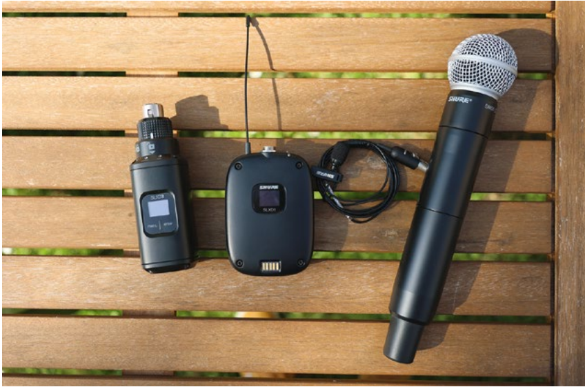
De gauche à droite, les émetteurs SLXD3, SLXD1 et SLXD2 permettent d'envisager de nombreuses utilisations : perche HF, micro main, micro lavalier...
