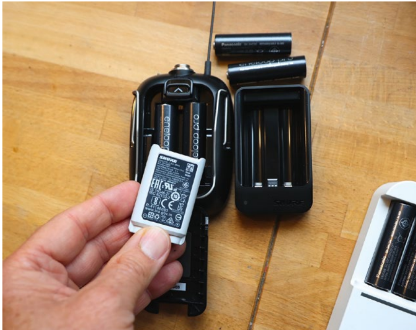
Piles LR6 rechargeables ou non, bloc d'accu SB 903 et USB-C font partie des options d'alimentation compatibles avec la gamme Shure SLXD.
