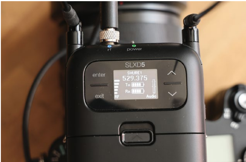
Gros plan sur le récepteur SLXD5 : le boîtier aluminium semble fait pour durer. Noter le switch de mise en route placé sur la partie supérieure du boîtier afin de simplifier l'utilisation en sacoche.
