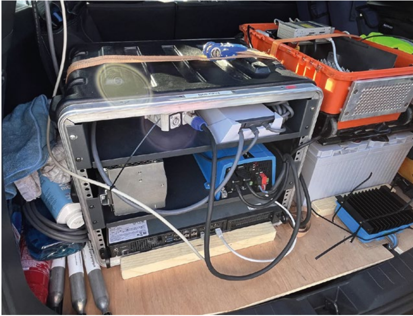
Le matériel nécessaire à la bulle 5G tient dans le coffre. Faire tenir le cœur de réseau 4G dans le coffre n'aurait pas été évident. Obvios héberge son cœur de réseau sur la machine 1RU en bas à gauche, avec le routeur Starlink en haut du flight case. La partie droite est occupée par les batteries et l'onduleur qui fournissent l'énergie la journée sans dépendre de la batterie de la voiture.
