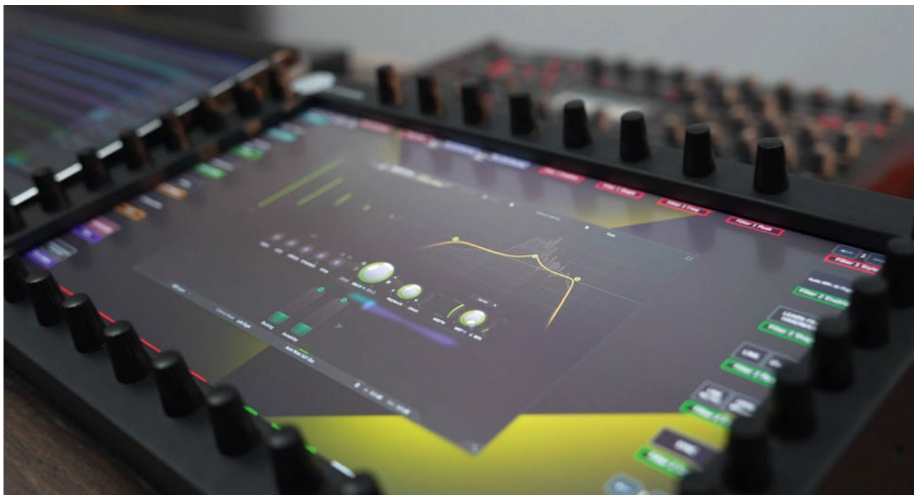
Le MP Midi Controller est une surface de contrôle équipée de trente-deux encodeurs rotatifs entièrement programmables à travers le protocole MIDI. Cela offre des perspectives de contrôle sans limite dans le monde de l'audio. © MP Midi
