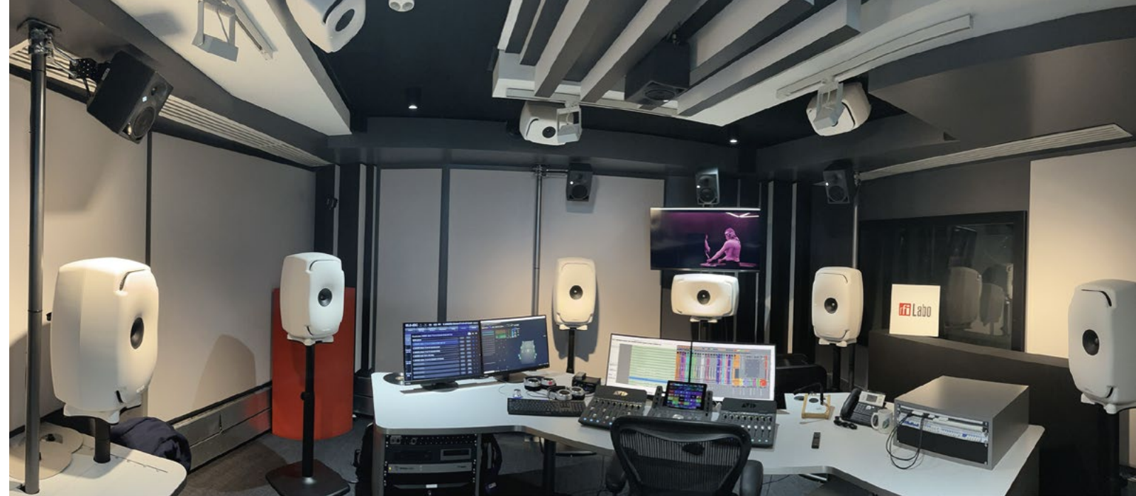
Vision (presque) complète du monitoring mixte Auro 3D et Dolby Atmos. Noter l'ensemble d'enceintes Genelec déployées ici en version blanche : 7 x 8 361 en bas, 4 x 8 341 au plafond plus un Sub 7380.
