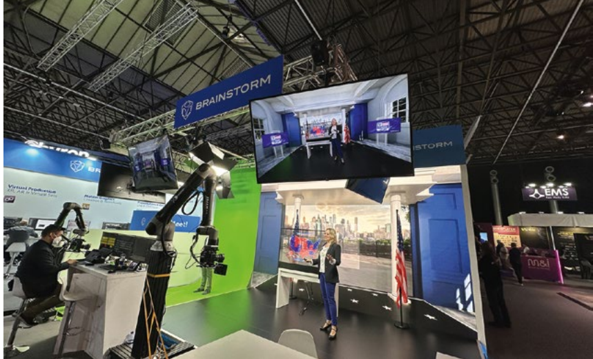
Brainstorm présentait en partenariat avec les bras robotisés de XD Motion un plateau virtuel associant un fond sur mur Led et un autre en fond vert pour un compositing en téléprésence invisibilisé. © Stephan Faudeux
