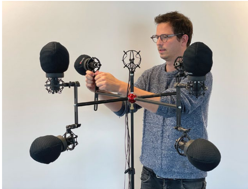
François Salmon, ingénieur R&D chez Noise Maker en plein montage d'un système de captation de réponses impulsionnelles spatiales mixte avec en périphérie, une configuration ESMA-3D (Equal Segment Microphone Array 3D) qui une fois finalisée comprendra huit micros. Au centre viendra prendre place un FRL Array : système dédié à la Spatial Decomposition Method.
