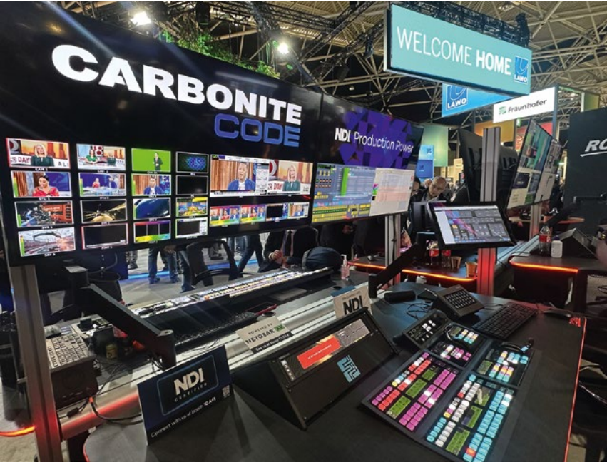
Le Carbonite Code, un mélangeur de production live basé sur logiciel et optimisé pour les flux de travail NDI. © Nathalie Klimberg
