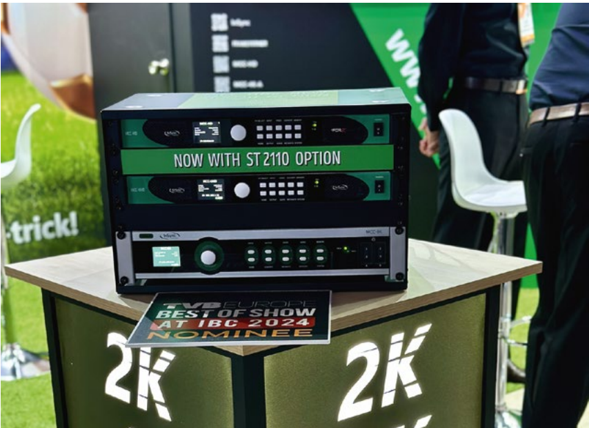
Un convertisseur double canal conforme SMPTE 2110 chez InSync Technology. © Nathalie Klimberg
