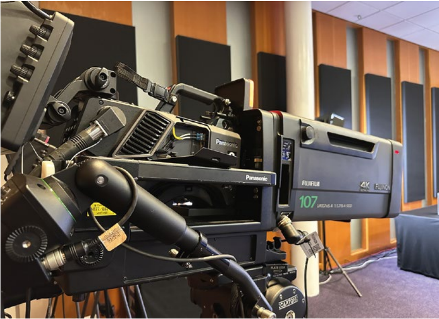
La nouvelle Panasonic UCX100, une caméra de studio compatible SMPTE ST 2110, offrant une vidéo 4K non compressée. © Nathalie Klimberg
