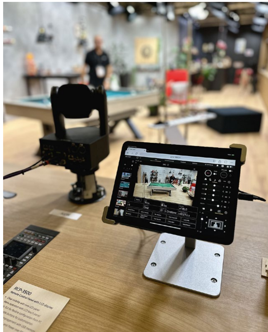
La caméra BRC-AM7 dispose de fonctions d'auto-framing (suivi de personnes) de très grande qualité et précision.
