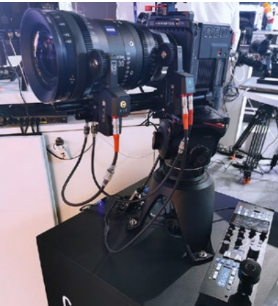
La télécommande RCP-J avec joystick de CyanView pilotait une caméra Red et les moteurs pilotant l'objectif associé. © Loïc Gagnant
