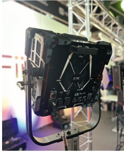
Le K10 de Fiilex, une unité composée de quatre lumières de 900 W avec un faisceau concentré. © Nathalie Klimberg
