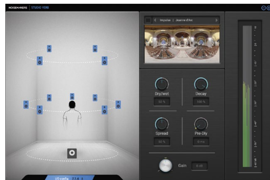
Le plug-in Studio Verb de Noise Makers : une réverbération multicanale particulièrement souple sur les formats d'entrée et de sortie, de la stéréo au 9.1.6 en passant par le 5.1, 7.1.4... La cinquantaine d'IR incluses (grand gymnase, salles de concert, églises, extérieurs, voitures, pièce de la vie) est amené à croître grâce à la facilité d'ajout d'IR et à la variété des formats pris en compte. Parmi les fonctions utiles en postproduction, on note le passage possible d'un snapshot à un autre et le paramètre spread qui permet de contrôler la sensation d'enveloppement via un seul paramètre.
