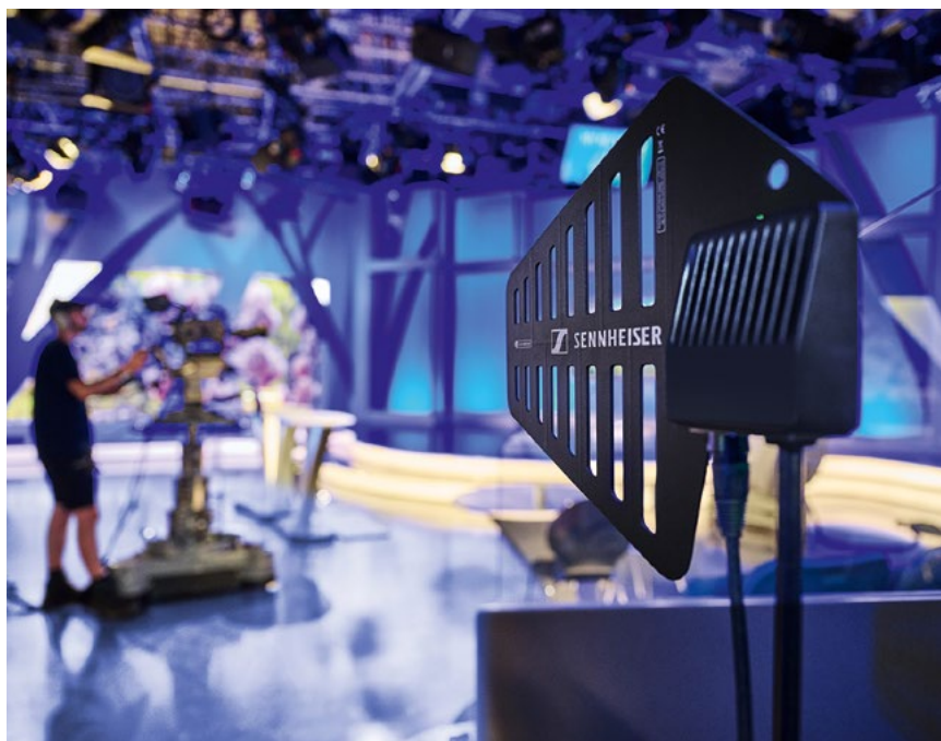
L'antenne d'émission-réception Spectera Digital Antenna Directional (DAD) gère simultanément les signaux des retours in-ear. © Sennheiser
