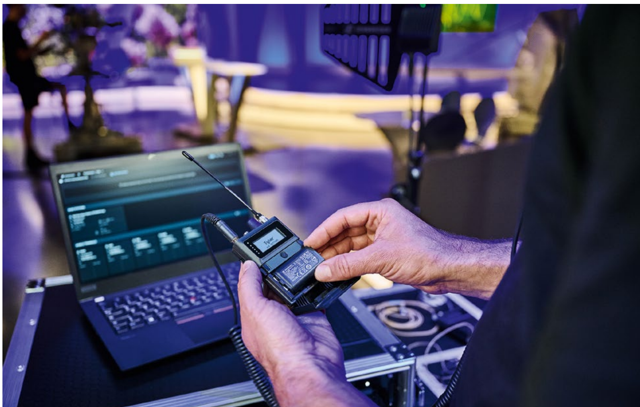
Bidirectionnel, le petit émetteur-récepteur de poche SEK gère les signaux micro et retour in-ear. © Sennheiser
