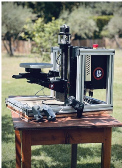
Après les grands travellings en hélico, Mikko a créé la Nano 360, une table de motion control.
