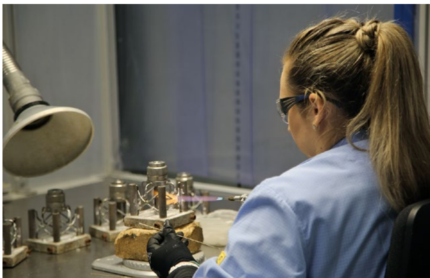
L'assemblage des suspensions de micros M 49 Neumann fait toujours l'objet de soudures à la main ! © Nathalie Klimberg
