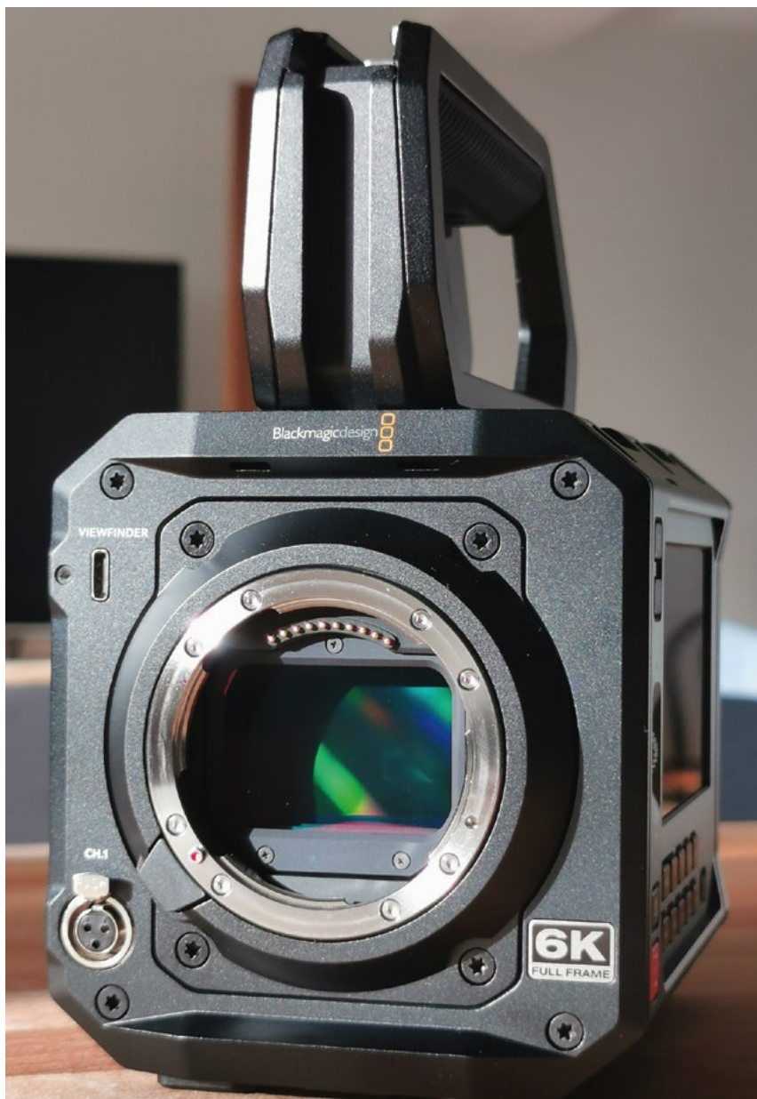
Le capteur de la Blackmagic Pyxis 6K est un modèle 6K Full Frame. © Loïc Gagnant
