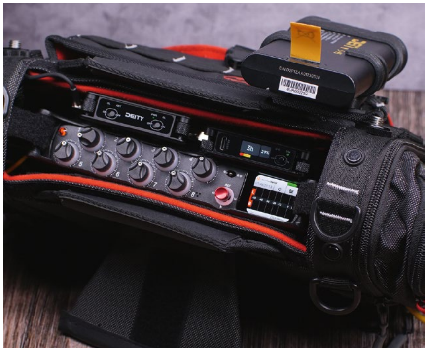
Dans cette mini sacoche accueillant une Sound-Devices MixPre 10, on trouve deux nouvelles solutions compactes proposées par Deity dans un format particulièrement compact : le distributeur d'alimentation SPD Mini (deux entrées HiRose+USB-C et cinq sorties Hirose) ainsi que le distributeur RF SRD mini.
