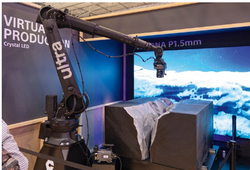
Sony présente une solution de Studio XR de taille réduite (pour du packshot par exemple), rendu possible grâce au capteur déporté de la Venice II, à sa technologie Led Verona P1.5 mm et un bras robotisé Cine Motion. © Luc Bara
