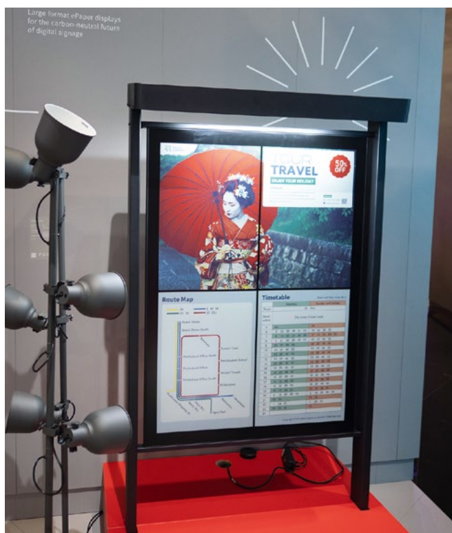
Sharp-NEC présente une solution ePaper outdoor, format A0, avec vitre anti-effraction et alimenté par des cellules photovoltaïques intégrées au caisson. © Luc Bara
