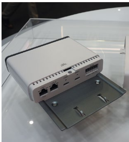
Xilica Room Hub, un tout petit DSP audio, qui comporte tout de même 8x8 Dante, 2in/2out en analogiques et 2 USB-C et le Bluetooth. © Antoine Gruber
