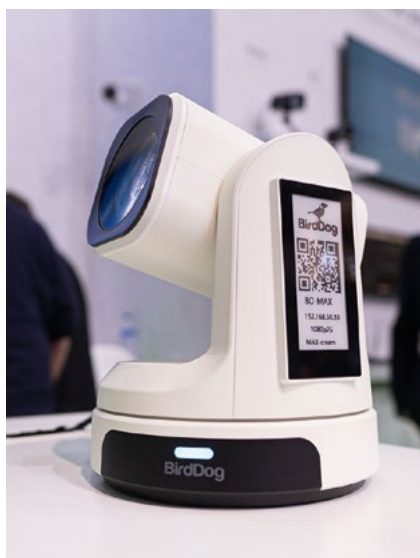
La nouvelle caméra BirdDog Max dispose d'un petit affichage ePaper configurable par exemple pour afficher un QR Code donnant accès à la configuration de la caméra. © Luc Bara
