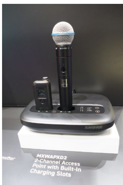
Une nouvelle génération de micros DECT chez Shure, avec moins de délais, et des bases de charge qui incluent récepteur et DSP, existe en version 2/4 ou 8 micros. © Antoine Gruber
