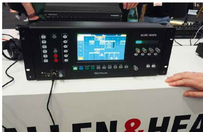
Allen & Heath décline sa console SQ en version rack, avec 48 entrées et 36 sorties, elle peut s'insérer dans de nombreuses applications mobiles par exemple. © Antoine Gruber
