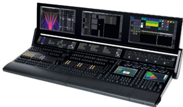
Sur les événements live et grâce au protocole DMX, les consoles grandMA3 gèrent aussi bien l'éclairage que les contenus dédiés au projection mapping. © MA Lighting
