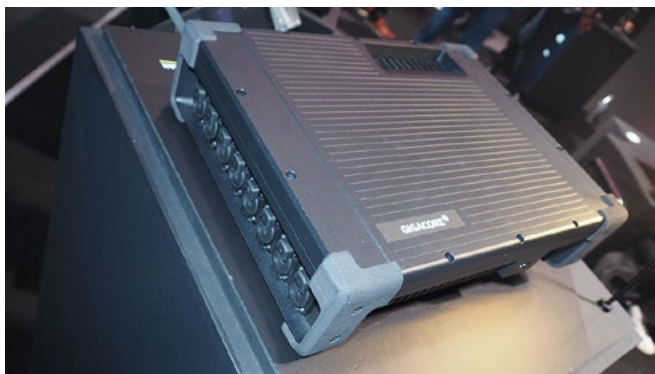
Chez Luminex on n'a pas peur de la pluie avec ce switch réseau IP65, entrée par fibre et huit sorties étanches, pour l'événementiel. © Antoine Gruber
