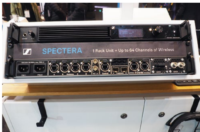
Un nouveau système de micro HF chez Sennheiser, Spectera assure 32 canaux émis et reçus sur un seul canal à large bande. Une vraie révolution pour les systèmes HF de spectacle qui simplifie la connexion de l'instrument et du retour avec un seul boîtier pour l'artiste. © Antoine Gruber
