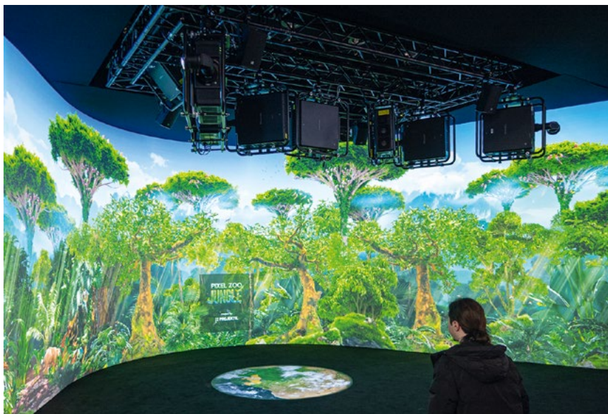
Show immersif sur le stand Panasonic Connect avec sept projecteurs PT-RQ25K (tri DLP, 20 000 lm) pour les murs et deux PT-REQ15 (mono DLP, 15 000 lm) pour le sol. © Luc Bara
