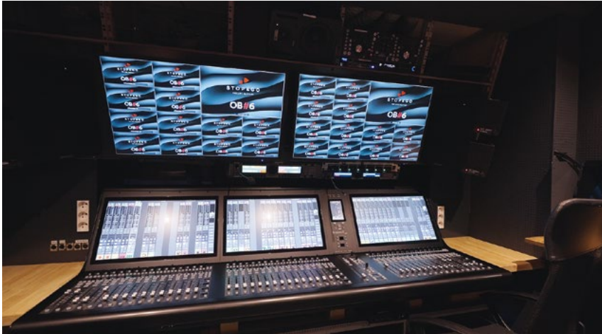
La partie audio repose sur une console SSL TS 400 une configuration déjà présente dans les autres unités de Stop & Go.
