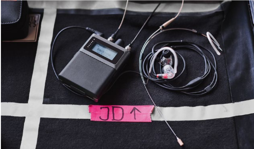
Gros plan sur le boîtier ceinture qui n'est plus seulement un émetteur mais aussi un récepteur IEM. Il est utilisé ici avec un micro serre-tête (Madona pour les intimes !) et des oreillettes in ear.
