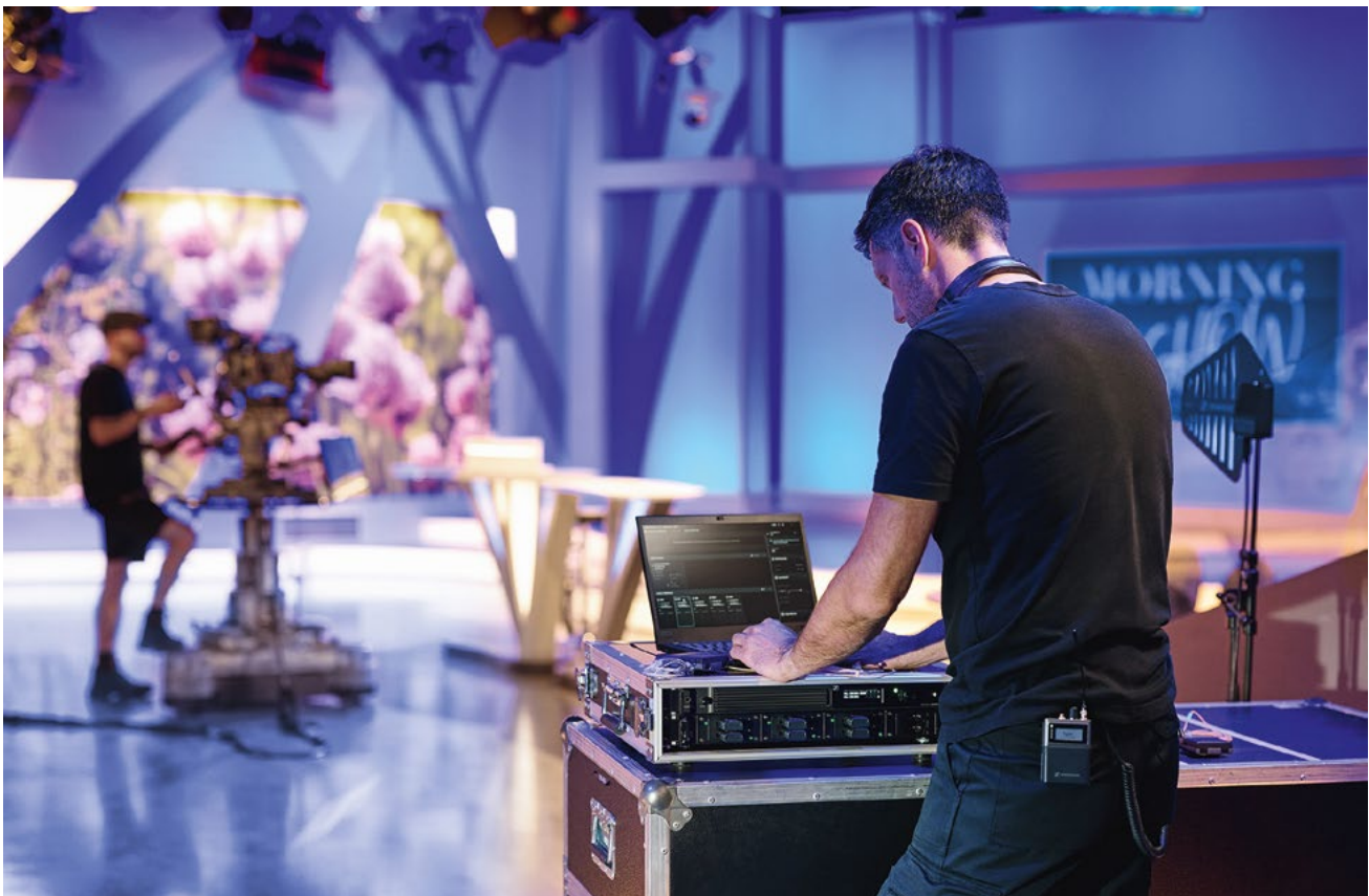
Le système Spectera déployé sur un plateau TV : noter le pilotage et le contrôle effectués via le logiciel LinkDesk et à droite, l'unique antenne DAD utilisée à la place des traditionnels couples Diversity.
