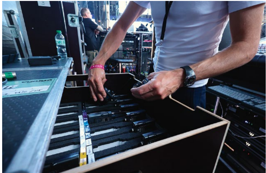
Les Pocket Spectera vont recevoir chacun un accu BA 70 leur assurant une autonomie supérieure à six heures. © Benoît Stefani
