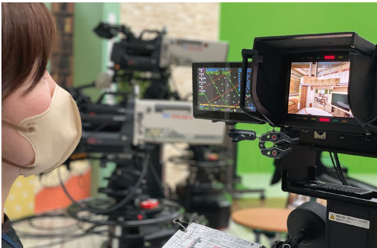
La grue est équipée pour la réalité virtuelle et la réalité augmentée. Sur l'écran de gauche, la personne au cadre vérifie que suffisamment de capteurs permettent le « tracking ». Une installation très soignée. © François Abbe
