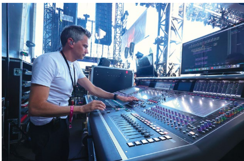
Julien Vouillon aux commandes de la console DiGiCo Quantum 7 dédiée au retour avant le concert. En arrière-plan, la présence des différentes antennes illustre la densité et la variété des systèmes HF devant cohabiter sur un festival comme les Francopholies. © Benoît Stefani
