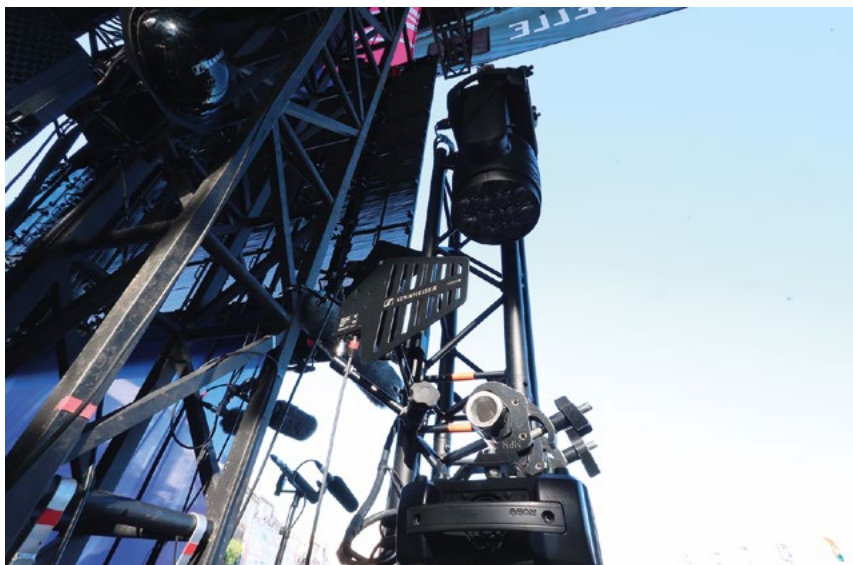
Gros plan sur l'une des antennes DAD utilisées par le système Spectera. Le câblage en RJ-45 garantit également l'alimentation via PoE. © Benoit Stefani
