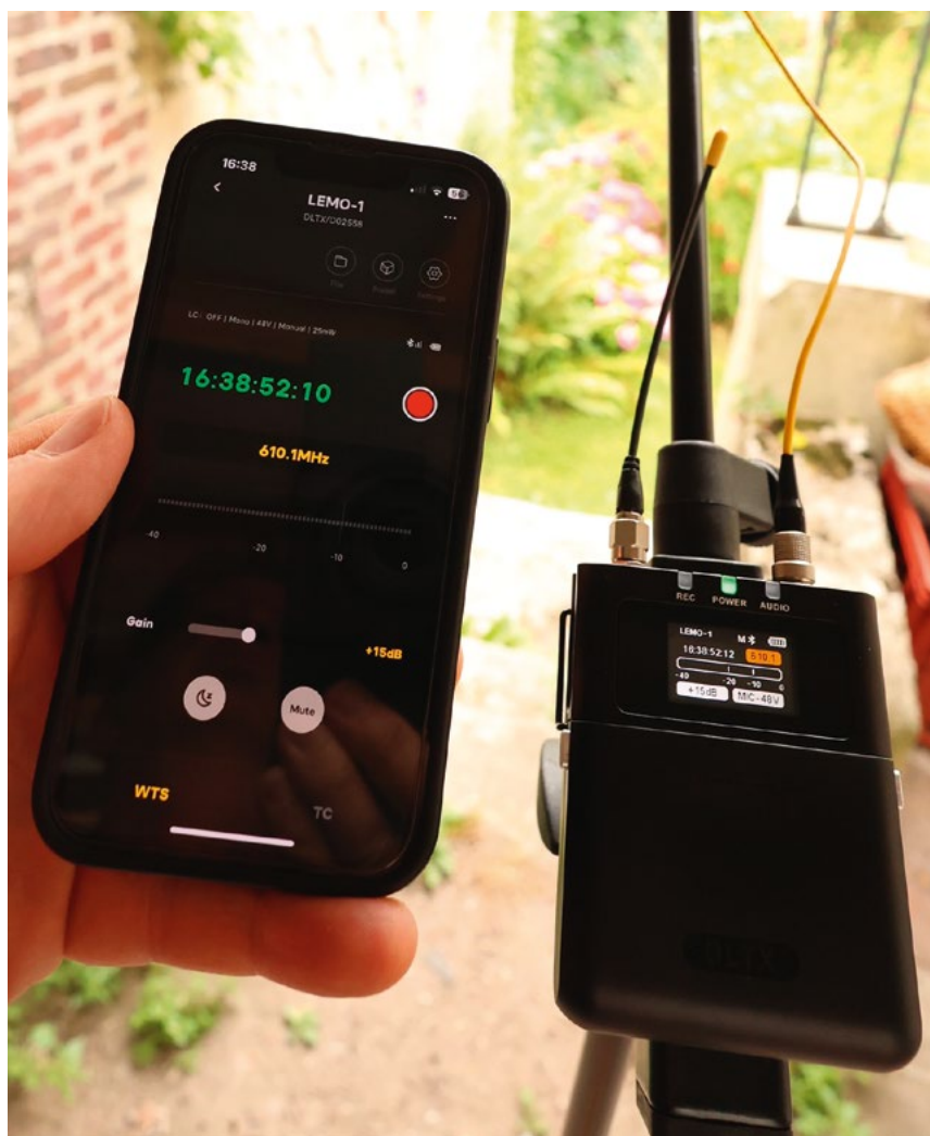
L'émetteur Theos DLTX ici prêt pour le pilotage depuis l'app Sidius reprend les mêmes caractéristiques que le DBTX, augmentée des possibilités offertes par son connecteur Lemo 3. © Benoît Stefani
