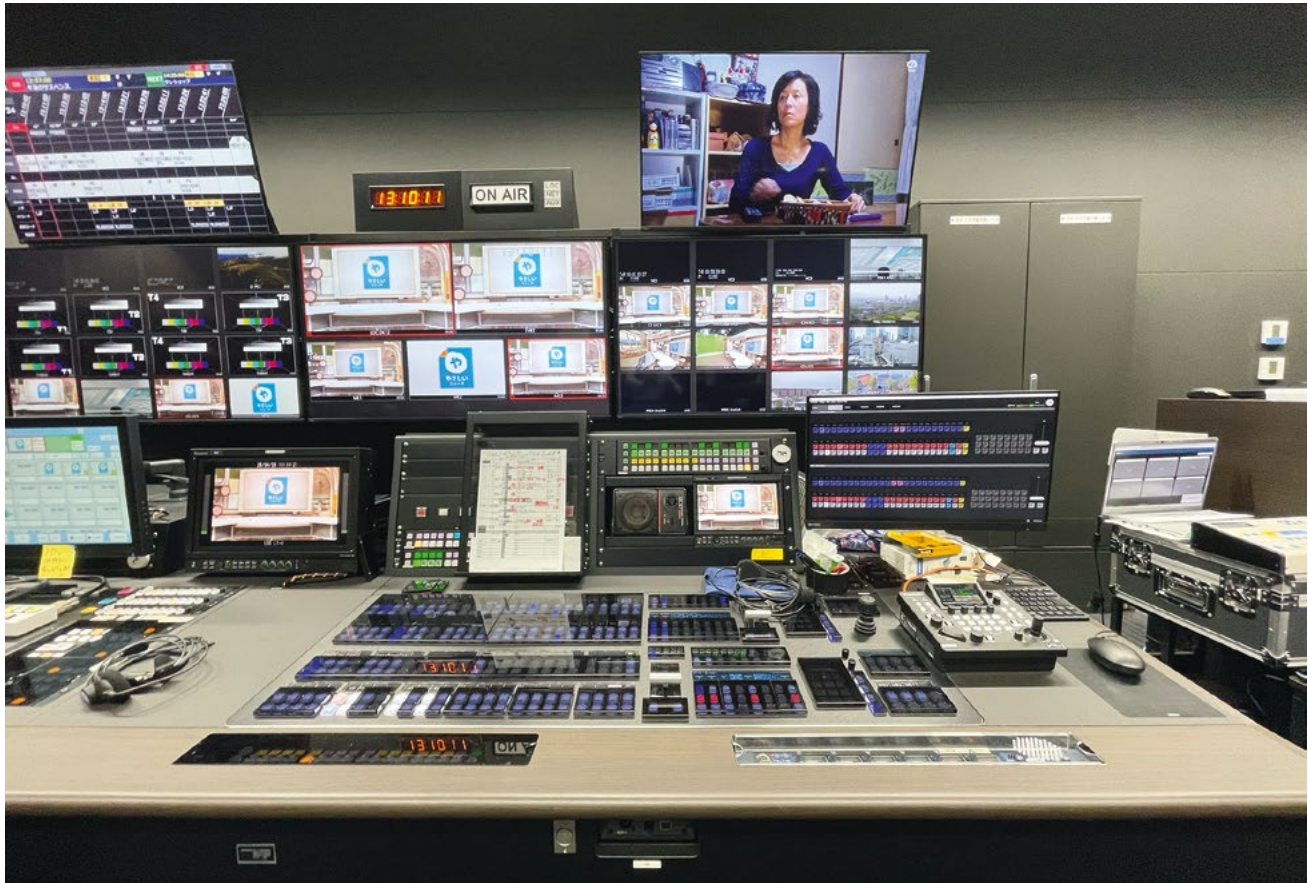
La régie est utilisée notamment pour l'info chez TV Osaka. Le mélangeur de Panasonic (au centre) génère les sorties pour les mosaïques en régie. © François Abbe
