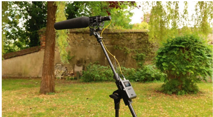
Perche HF ou captation déportée d'ambiances et de sons seuls font parties des applications facilement envisageables avec l'émetteur DLTXT. © Benoit Stefani
