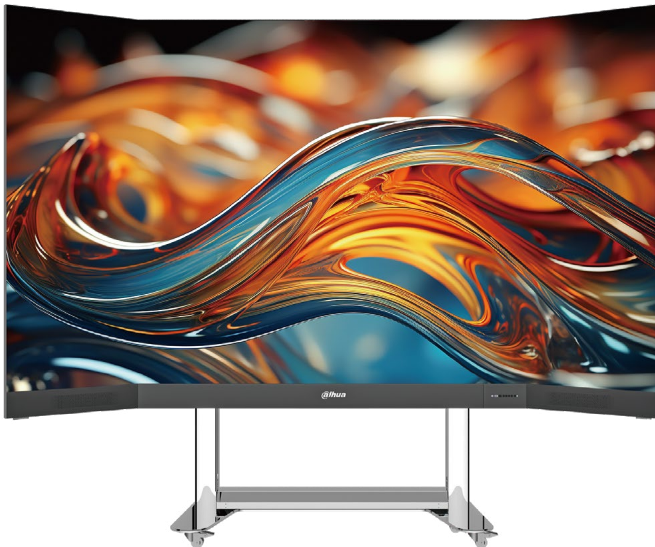
Le Dahua UH est un écran pliable de 135" lié à un chariot motorisé afin d'obtenir la bonne hauteur pour une vision optimale. © Dahua
