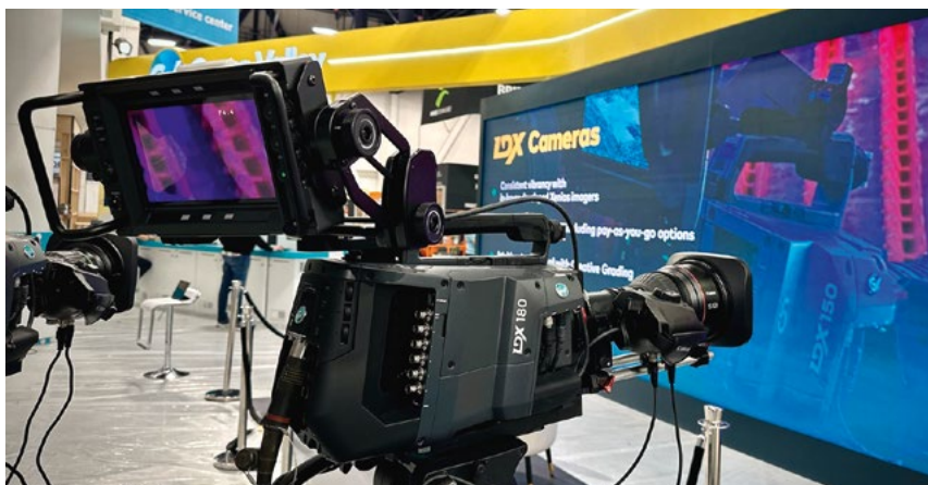
La caméra Grass Valley LDX 180 possède un capteur Super 35 pour faire des prises vues très cinématographiques pour le Live.
