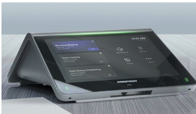
Dans une salle autonome, l'ordinateur fixe ou le NUC est associé à une platine tactile affichant l'agenda des réunions et la gestion des visioconférences comme sur la platine Flex MM de Crestron. © Crestron
