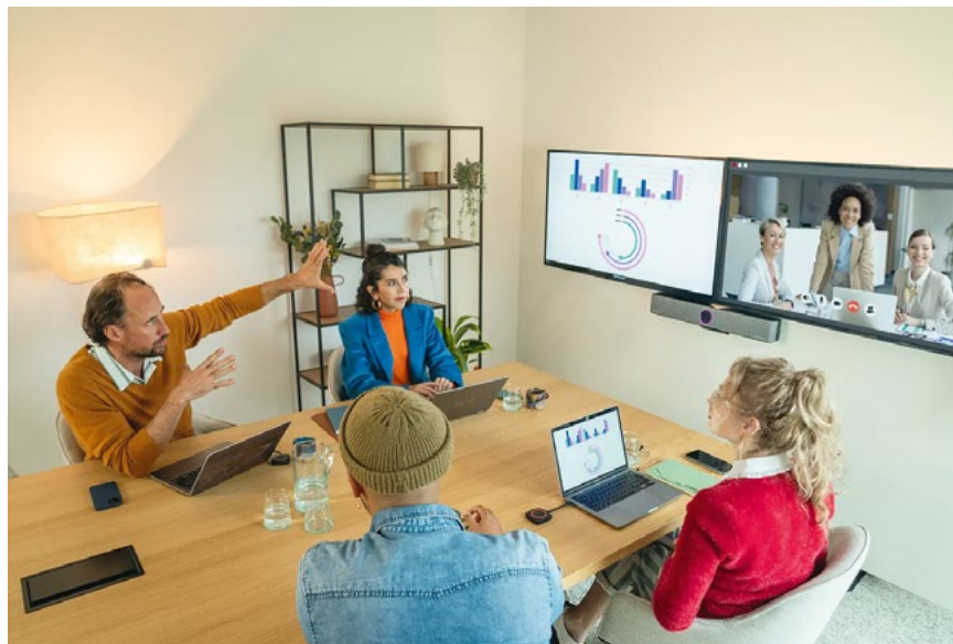
Dans ses ClickShare Bars, Barco a regroupé une caméra vidéo, des haut-parleurs, des micros et une base ClickShare Conférence pour une liaison sans fil entre l'ordinateur portable et l'écran. © Barco
