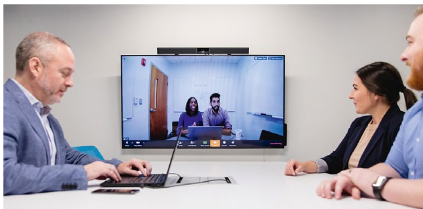
La barre vidéo VB1 de Bose Professional regroupe dans un boîtier unique une caméra 4K avec fonction PTZ, six capsules micros et une sonorisation avec une puissance de vingt watts. © Bose Professional
