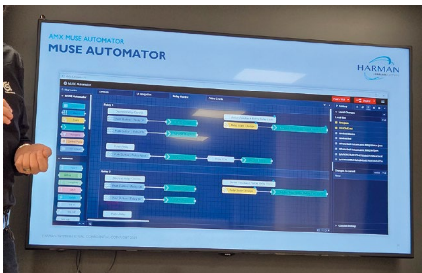
Le logiciel de contrôle MUSE Automator fonctionne avec un système de blocs. © Paul-Alexandre Muller
